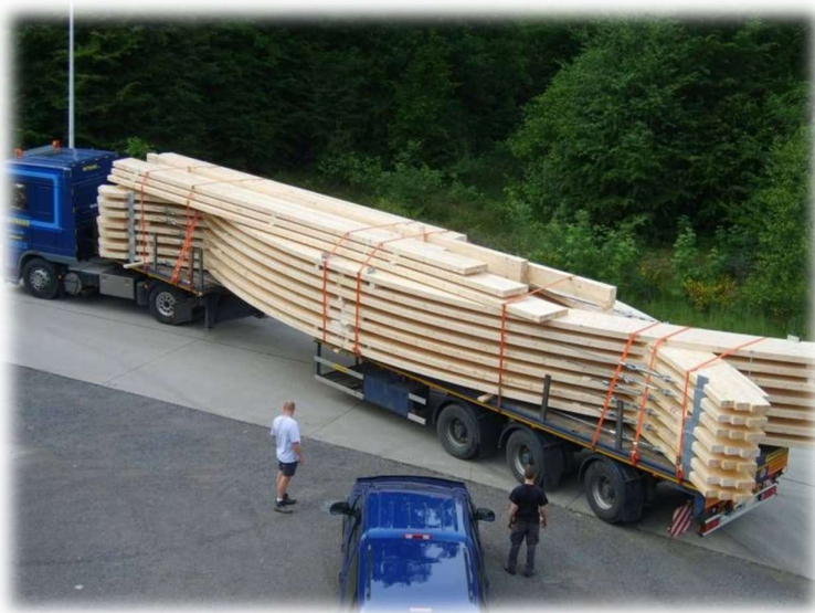
Obr. 4.5 Přeprava nosníku z lepeného lamelového dřeva
