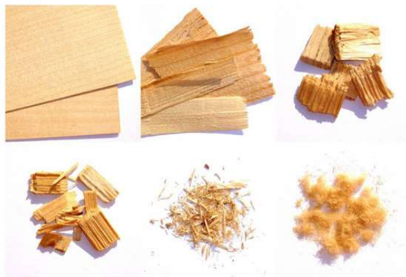
Obr. 19 – Příklad dřevních částí používaných pro výrobu materiálů na bázi dřeva (zleva shora): dýha, velké ploché třísky na výrobu OSB, papírenská štěpka, štěpka pro výrobu třísek a vláken, třísky, vlákna
