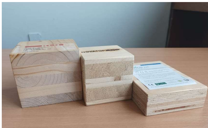
Obr. 36 – Rozdíl v tloušťce lamel v systému NOVATOP
