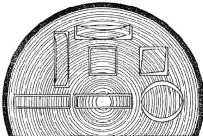
Obr. 8 – Závislost příčného borcení na vzdálenosti dřevěného prvku od dřevě kmene stromu
