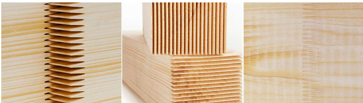
Obr. 7 - Klínovitý zubovitý spoj KVH hranolů [21]
