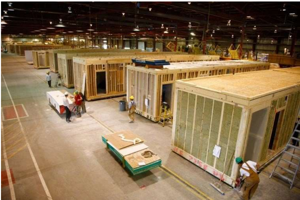
Obr. 29 - Kompletace modulů ve výrobní hale [42]
