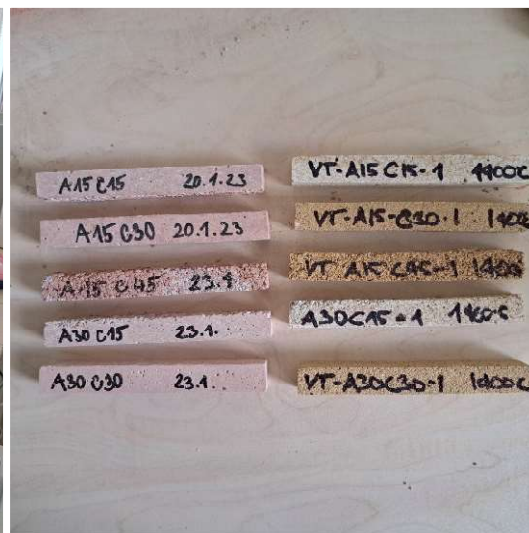
obr. 9: Vzorky před a po měření teplotní dilatace
