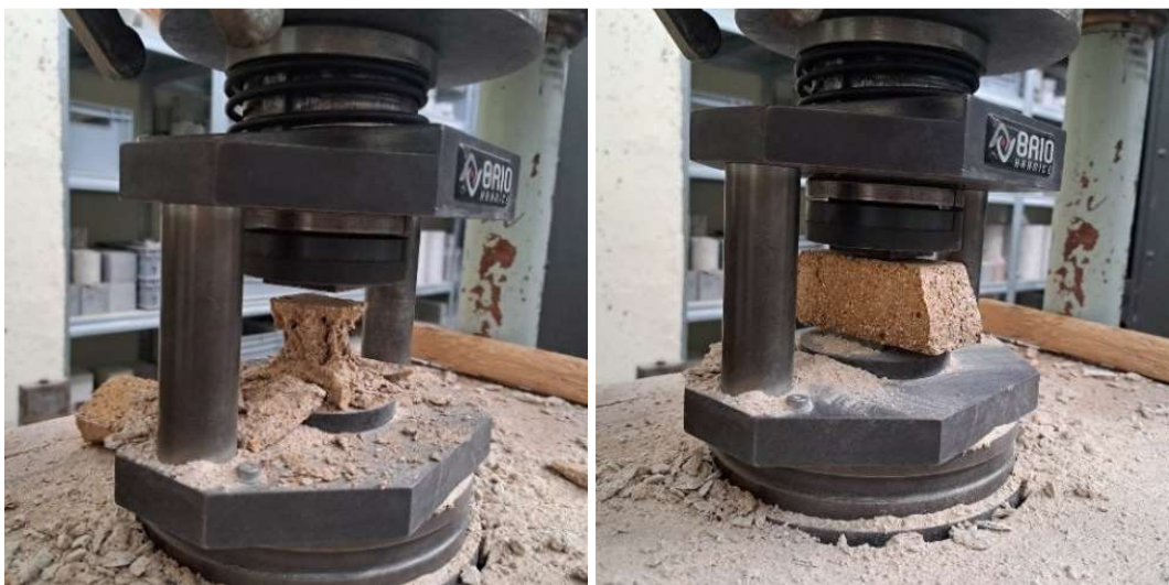
obr. 11: Průběh zkoušky pevnosti v tlaku
