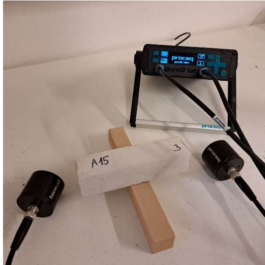
obr. 12: Měření dynamického modulu pružnosti
