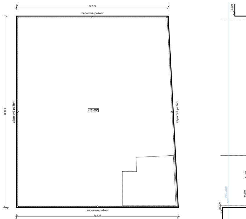
obrázek 8 - návrh stavební jámy
