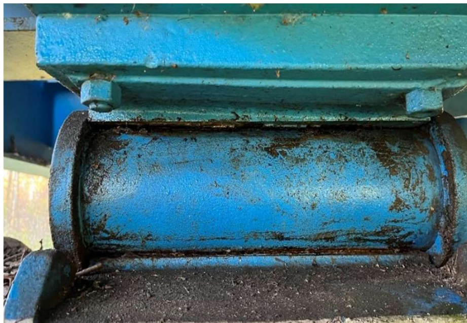
Obrázek 15: Podélně posuvné ložisko K05 [2]
