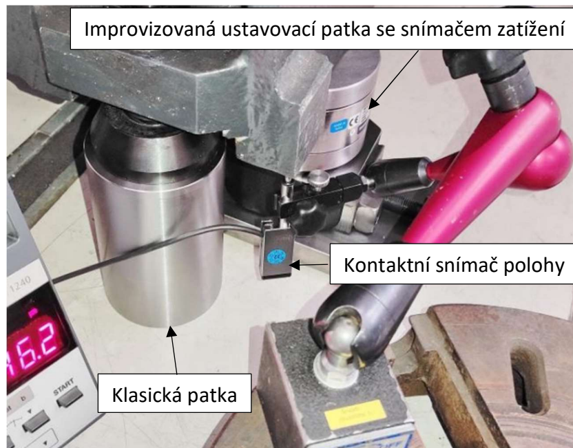
Obr. 21 - Improvizovaná konstrukce ustavovacího elementu [1]
