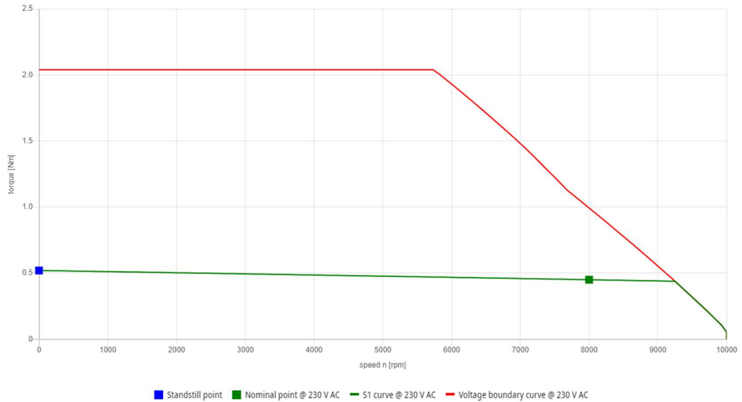
Obr. 28 - Beckhoff AM8013 krouticí moment/otáčky [26]
