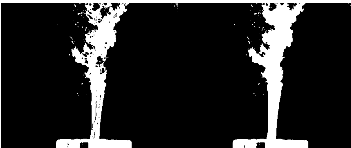
Obrázek 3.5: Segmentovaný snímek před (vlevo) a po aplikaci vyplňovací funkce
