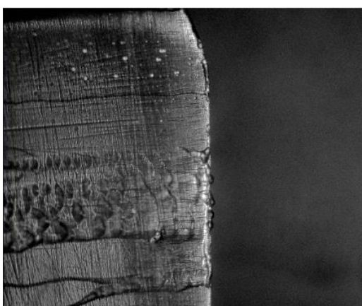
Obrázek 4.5: Odtékání vody z lopatky při rychlosti 190 m/s
