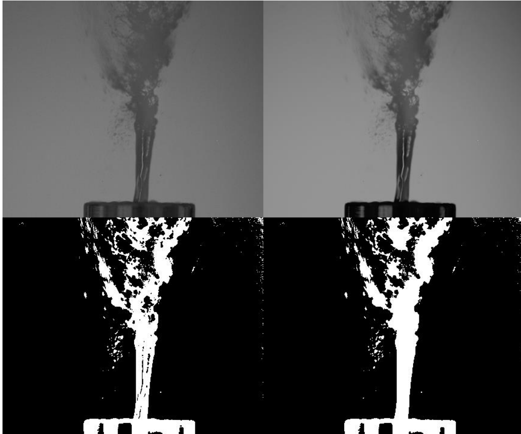
Obrázek 3.9: Adaptivní prahování – funkce světlého pozadí; zleva shora: černobílý snímek, snímek s upraveným jase; zleva dole: segmentovaný snímek, snímek s vyplněnými dírami
