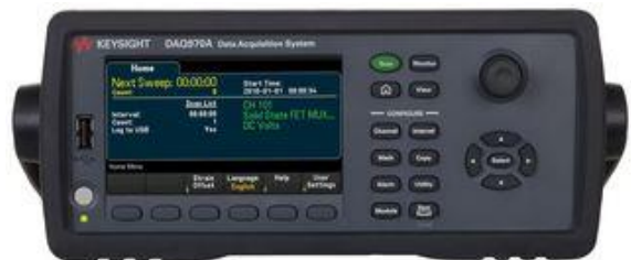
Obrázek 5.7 Měřicí stanice pro vyhodnocení termočlánku [38]
