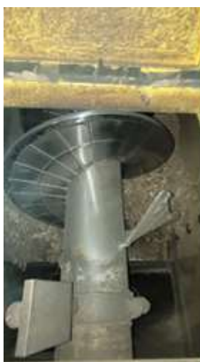
Obrázek 11: Původní šnekový podavač provozního zásobníku dřevní štěpky je velmi podobný tomu novému
