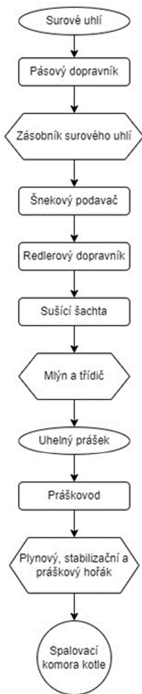
Obrázek 5: Porovnání vnitřního palivového hospodářství před a po přestavbě formou diagramu
