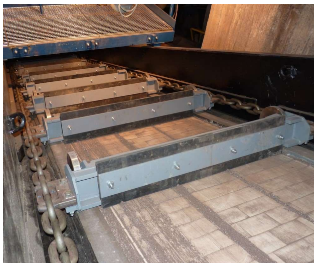
Obrázek 15: Ukázka mokrého vynašeče s abrazi vzdornou výstelkou [30]
