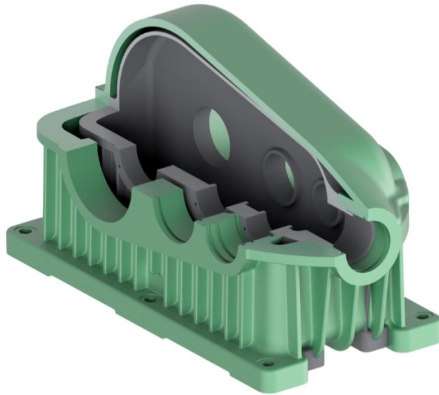
Obr. 20: Porovnání odlitků zadané (zelené) a nově navržené (šedé) skříně ze stejné litiny
