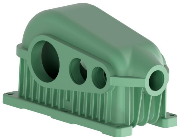
Obr. 19: Zjednodušený model odlitku stávající skříně převodovky
