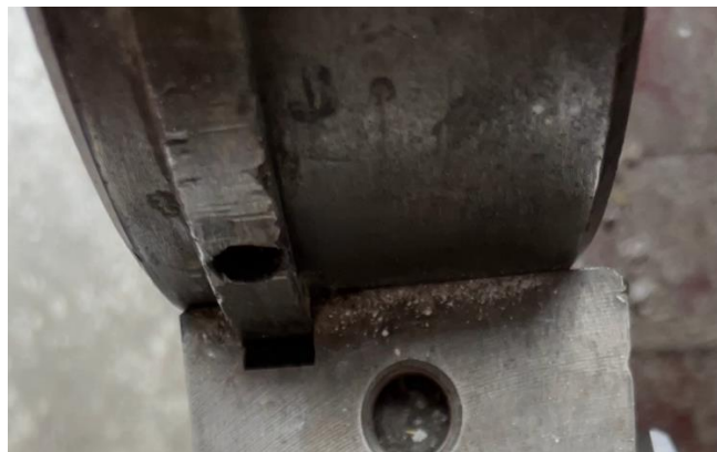
Obr. 37: Foto lokalizace ložiskového domku pomocí osazení na výstupním hřídeli
