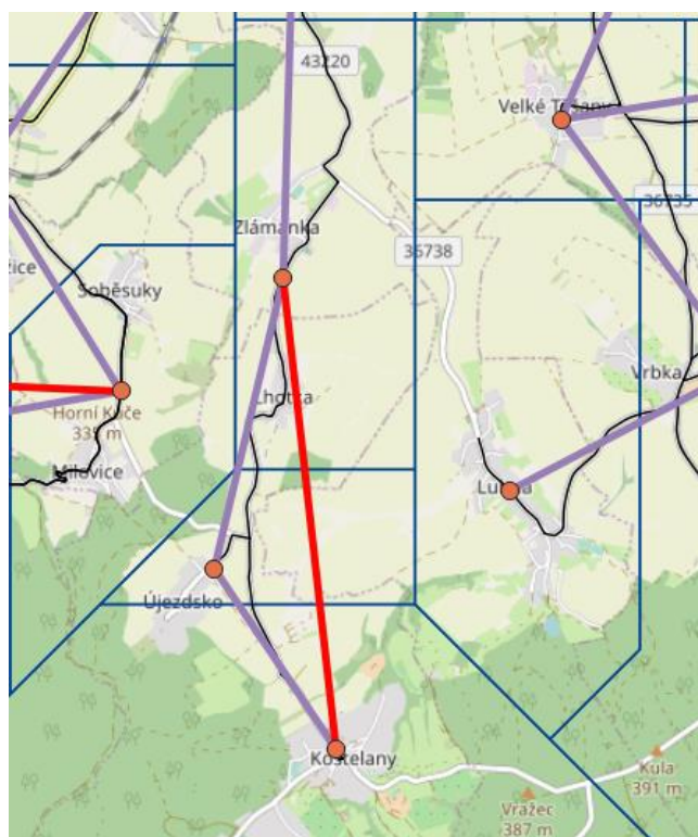
Obrázek 6: Jednoduchý příklad hrany druhého typu (červeně) mezi zónou Lhotka/Zlámanka a Kostelany, jejímž účelem je, aby se do tarifní vzdálenosti Kroměříž–Kostelany nezapočítával zázvek do Újezdska.
