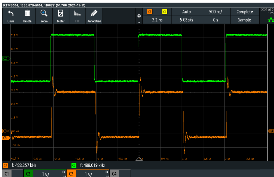
Obr. 5.5: PWM signál na osciloskopu Rhode & Schwarz RTM3004, oranžový je ze Zbyto Z7 a zelený je z generátoru Rigol DG4162
