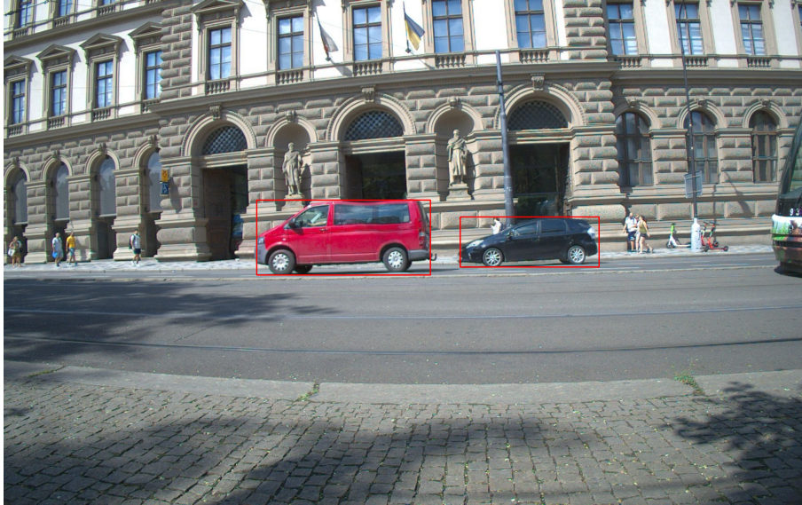
Obrázek 3.4. Ukázka 2D detekce YOLOv5 na interpolovaném snímku pomocí sítě RIFE .
