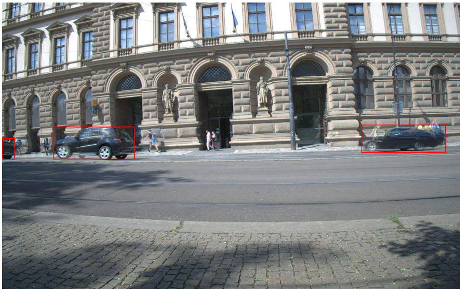
Obrázek 3.5. Ukázka 2D detekce YOLOv5 na interpolovaném snímku pomocí sítě RIFE obsahujícím zkreslení objektů. Kvalita detekce není zkreslením výrazně ovlivněna.
