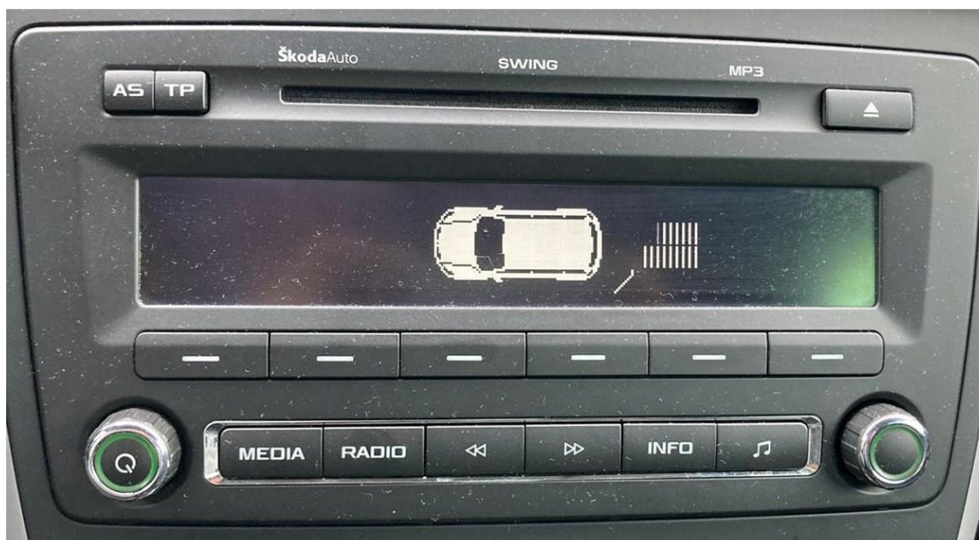
Obrázek 4.3 - Zobrazování vzdálenost překážek vozidla na černobílém displeji rádia [16]
