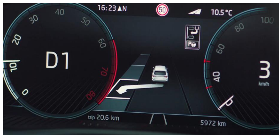
Obrázek 4.5 - Displej virtuálního kokpitu ukazující možnost zaparkování na levou stranu vozovky [19]
