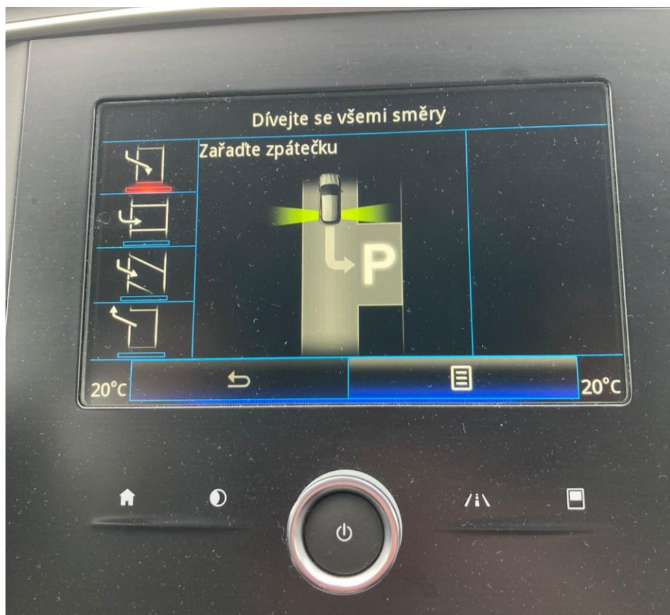
Obrázek 12.1 - Obrazovka rádia zobrazující zvolený parkovací manévr - Renault Megane
