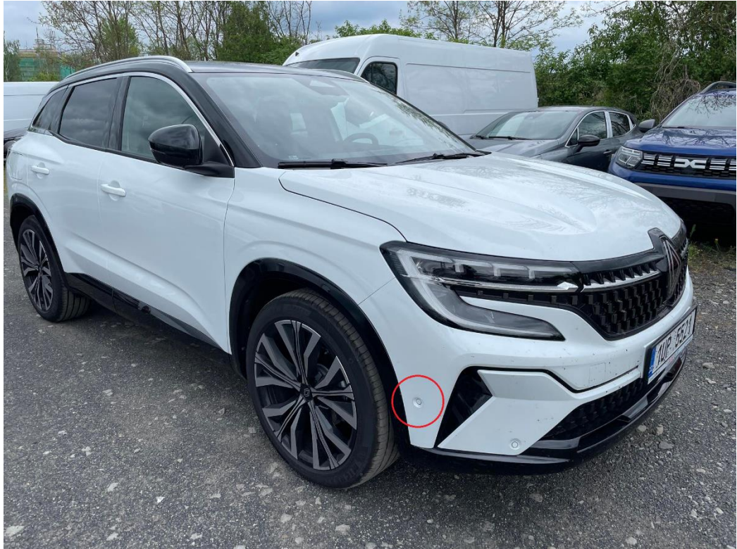
Obrázek 12.4 - Fotografie předního PLA senzoru na vozidle Renault Austral 2023
