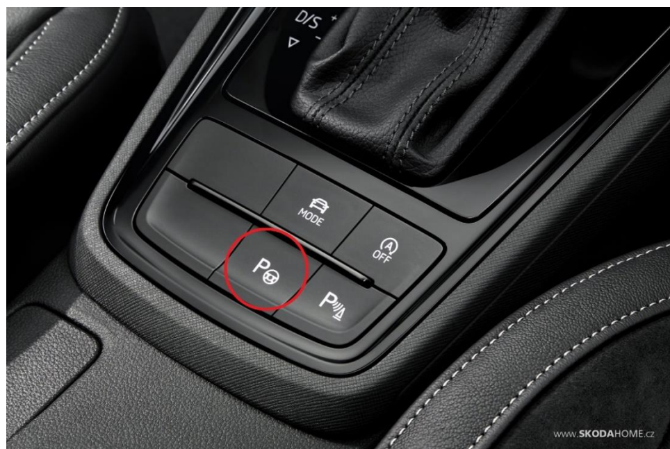
Obrázek 4.7 - Tlačítko, které aktivuje PLA parkovací asistenci [20]
