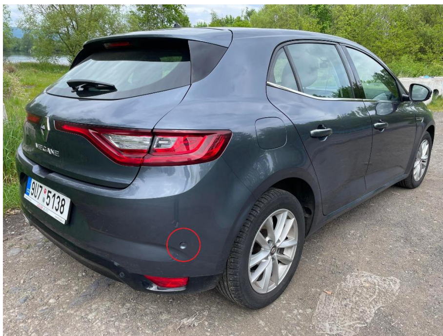
Obrázek 12.2 - Fotografie zadního PLA senzoru na vozidle Renault Megane 2018
