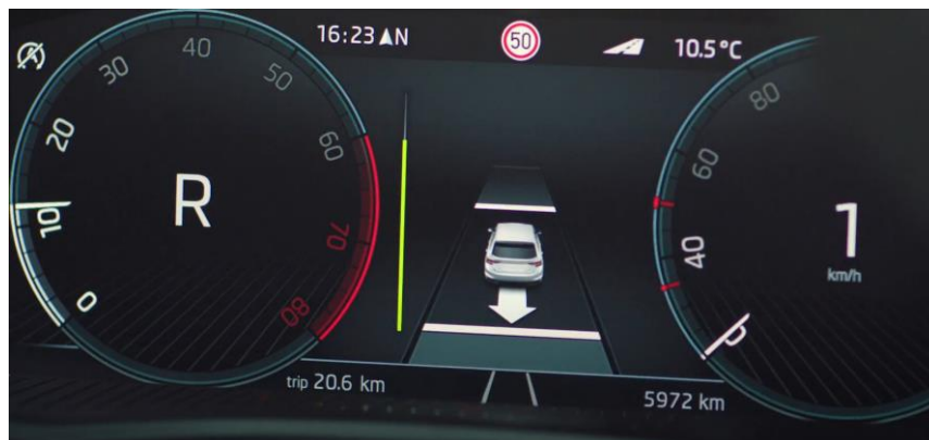
Obrázek 4.6 - Displej virtuálního kokpitu zobrazující požadovaný směr jízdy vozidla a progress bar ukazující, jak velkou dráhu musí vozidlo urazit [19]
