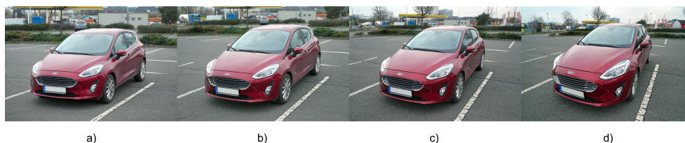
Obrázek 3.1: Ukázka vlivu různých ohniskových vzdáleností na změnu obrazu. Ohniskové vzdálenosti: a) 75 mm b) 50 mm c) 35 mm d) 24 mm
