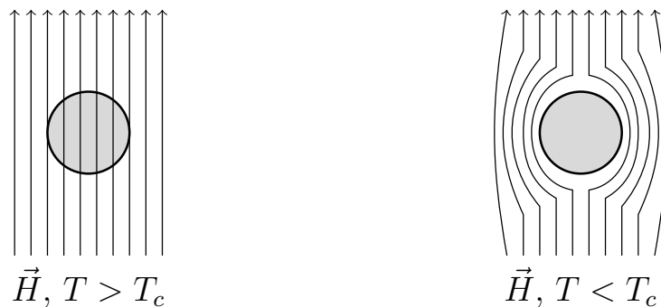
Obrázek 9.2: Supravodič (šedý kruh) uvnitř magnetického pole nad kritickou teplotou (vlevo) a pod kritickou teplotou (vpravo)
