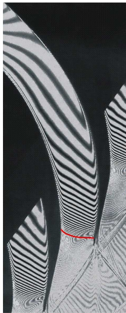
a) s/c = 0,2603 b) s/c = 0,2732 Obrázek 10: Vliv změny poměrné rozteče ( s/c ) na tvar zvukové čáry v mezilopatkovém kanále – experiment, interferogram. Výstupní Machovo číslo M_{2is} \sim 1,8 , úhel náběhu \iota = 14^\circ (nominální vstupní úhel) [A5], [A6].
