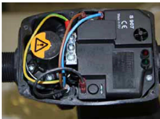
Obr. 10 Základní ovládání čerpadla
