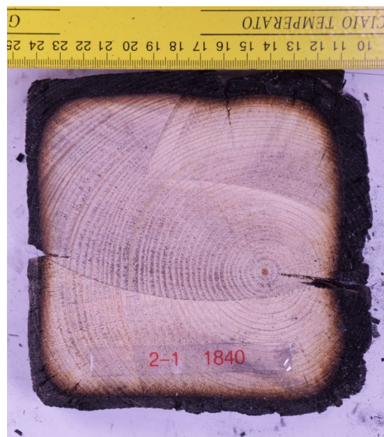
b) Průřez sloupu po požáru
