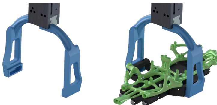
Obrázek 40 - Prsty pro robot IRB1300 s ukázkou uchopení paletky
