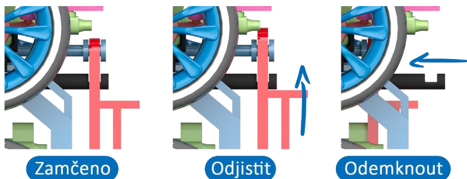
Obrázek 38 - Mechanismus pro odemčení os na zadní části paletky
