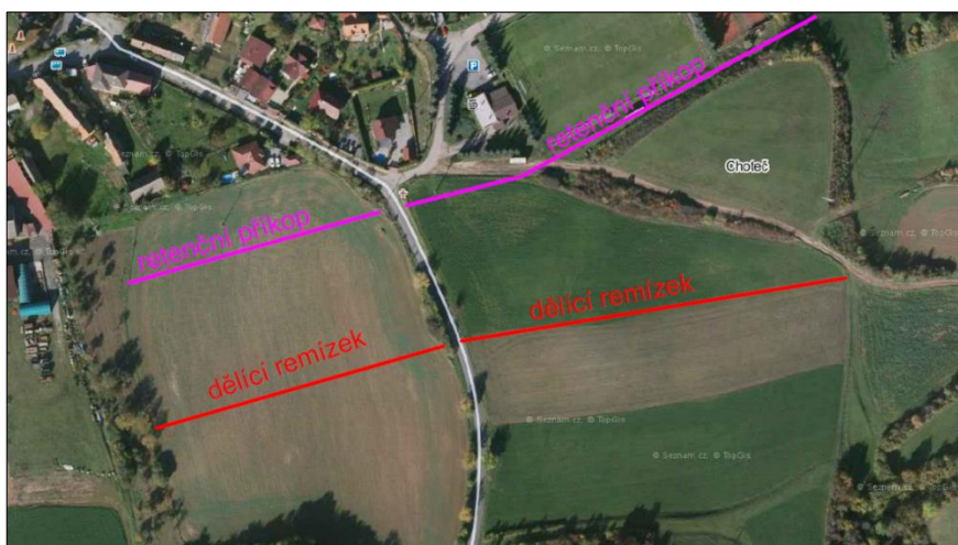
Obr. 53: Možný návrh opatření proti nátok extraviánových vod z jižního směru
