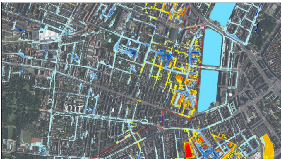
Obr. 5: Hydraulický modelu záplavy v Kodani roku 2011 [8]
