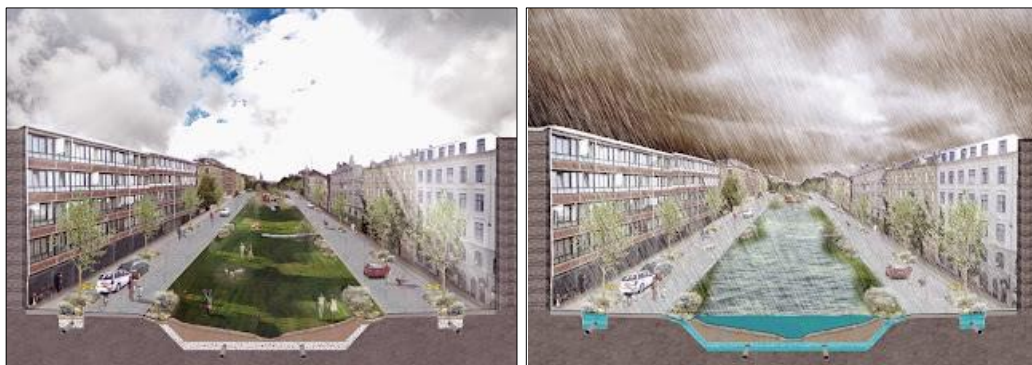
Obr. 19: Povodňový koridor s MZI za bezdeštného období (vlevo) a za dešťové události (vpravo) [30]
