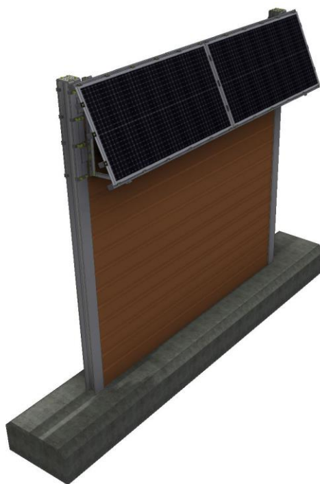
Obr. 38 Trojrozměrná vizualizace fotovoltaické protihlukové stěny společnosti KuPr System s konfigurací typu 1 (vrchní konstrukce) [112]
