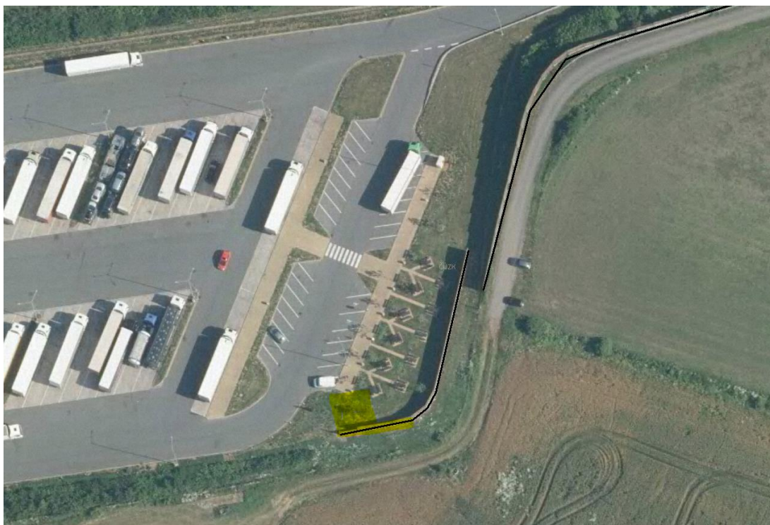
Obr. 41 Satelitní snímek odpočívky na dálnici D11 v obci Osice s vyznačenými protihlukovými stěnami (černé) a se zvýrazněnou částí stěny a prostorem vyhrazeným pro pilotní projekt FVPHS [zdroj: ŘSD]
