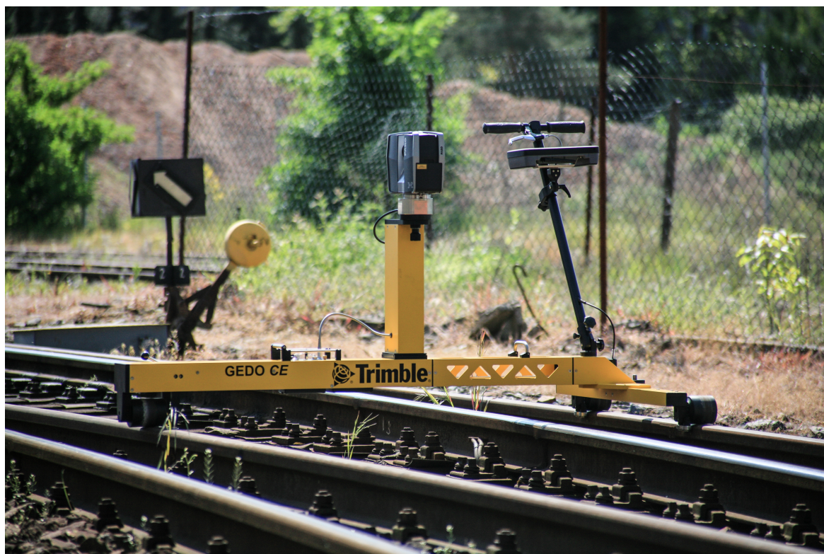
Obrázek 2.4: Malý měřicí systém. Zdroj: https://www.tudc.cz/wp-content/uploads/2017/05/mms2.jpg
