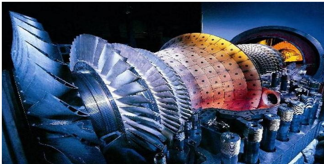
Obr. 7.1 – Umístění tepelných štítů na plynové turbíně
