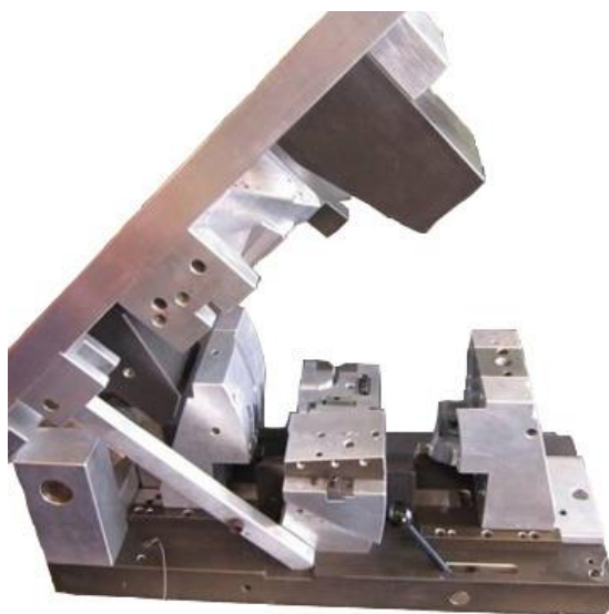
Obr. 5.2: Matečná forma pro výrobu voskového modelu
