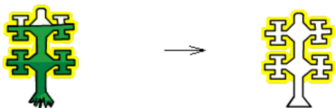
Obr. 2.2.1 Procesní schéma technologie lití na vytavitelný model [2.4], [H1]
