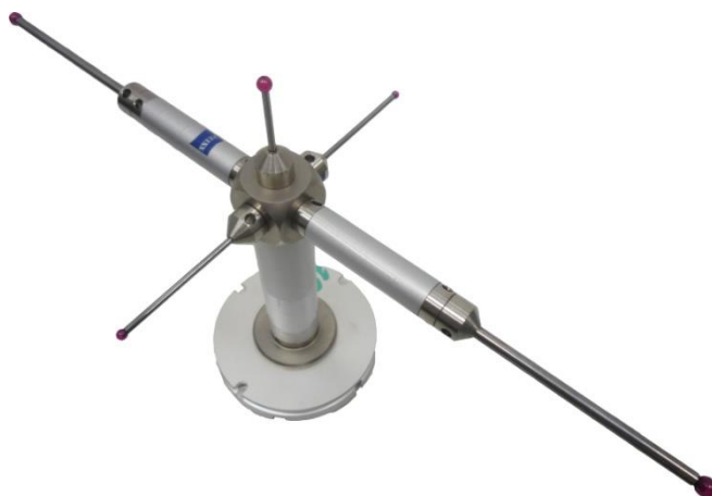
Obr. 5.9: Použitá hlava se sestavenými snímači v požadovaných směrech
