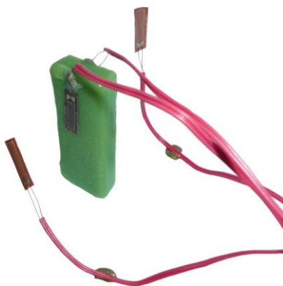
Obr. 4.61 Sestava voskového vzorku s tenzometry
