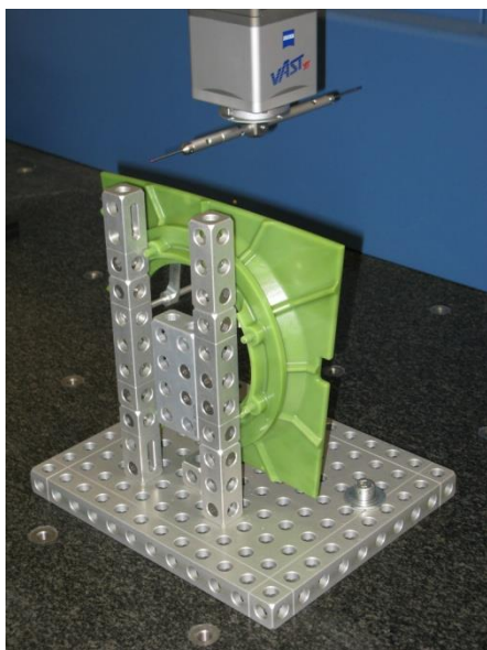
Obr. 7.9– Upevnění voskového modelu do přípravku pro měření
