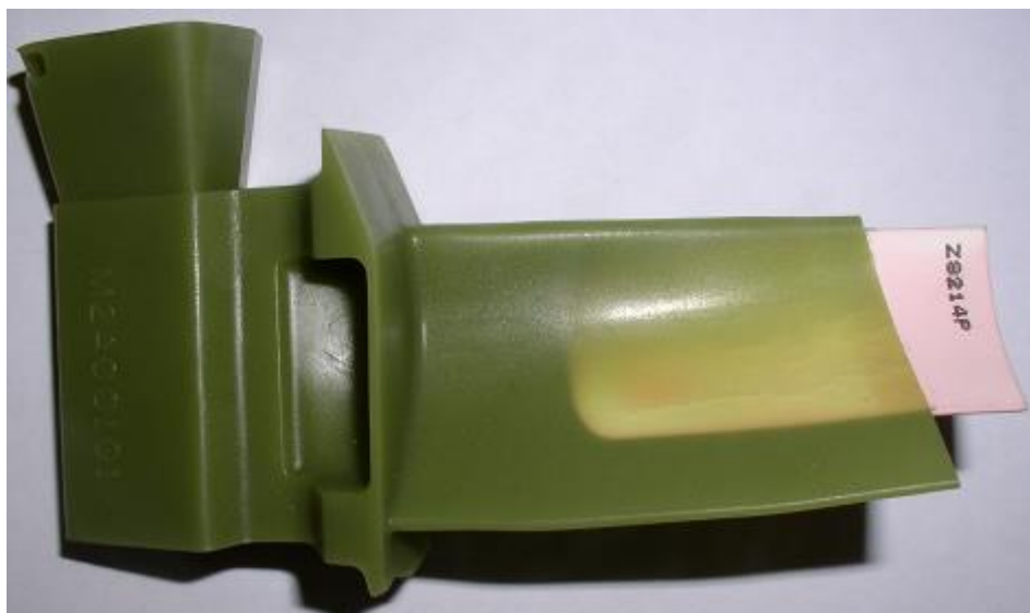
Obr. 2.3.4.2. Keramické jádro (vložené ve voskovém modelu)
