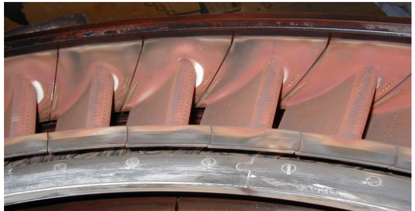
Obr. 1.3 Sestava chlazených segmentů v turbíně
