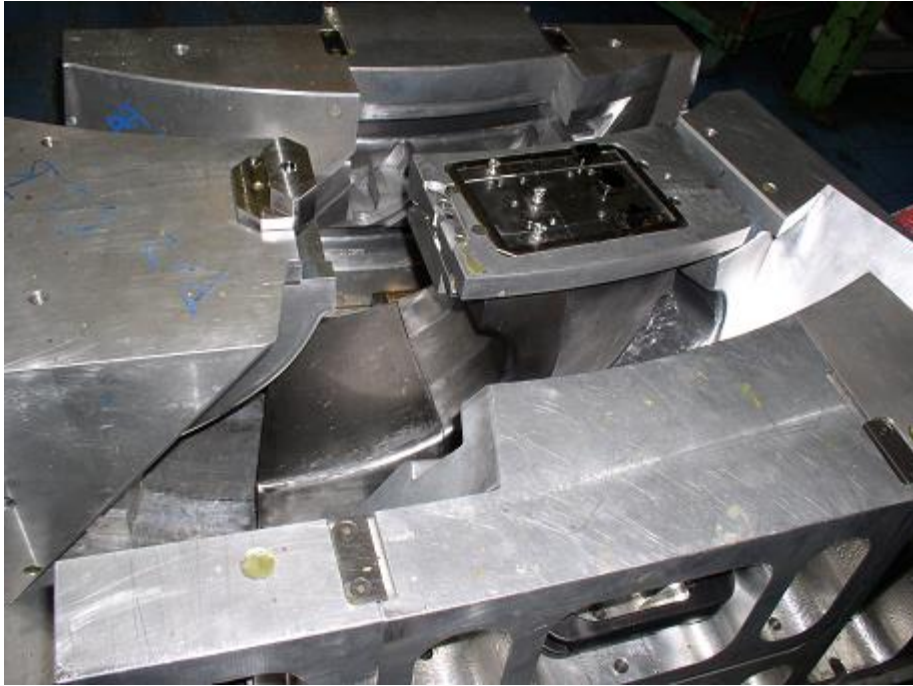
Obr. 2.2.3. Forma s výsuvnými částmi vyrobená obráběním
