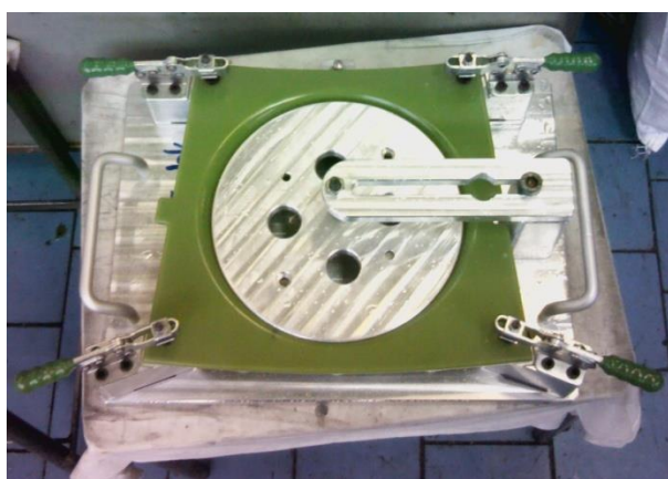
Obr. 7.4 – Konečné upevnění voskového modelu
