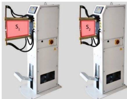
Obr. 3.41: Porovnání velikosti jalového odporu v závislosti na vyložení ramen
