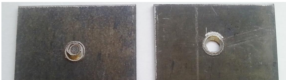
Obr. 11.33: Vytržená část svaru M26 (vlevo) a otvor po vytržené části svaru (vpravo), svařováno na zařízením s adaptivním řízením
