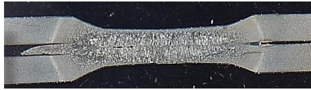
Obr. 11.28: Metalografický výbrus svaru T621 s výstřikem svarového kovu a velkou hloubkou vtisků po elektrodách, zvětšení 25x
