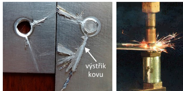
Obr. 3.14: Výstřik kovu při bodovém odporovém svařování [37]
