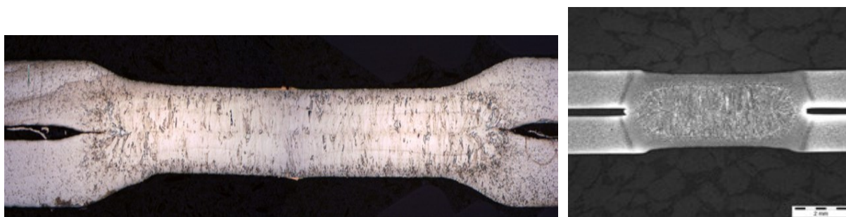
Obr. 3.28: Vady bodových spojů: P 5214 – průměr čočky je příliš velký (vlevo) [51], P 525 – nadměrné rozevření plechů (vpravo) [50]
