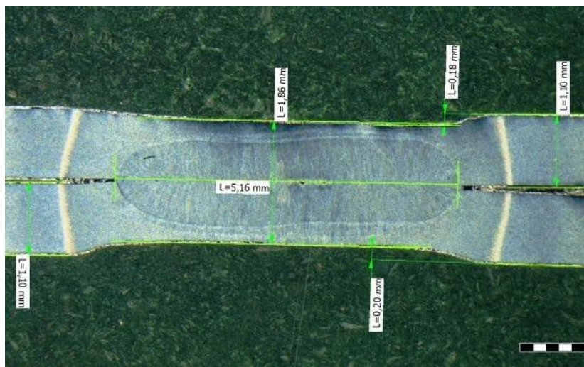
Obr. 11.12: Metalografický výbrus svaru (ocel 22MnB5 s povlakem AISi) svařeného optimálními svařovacími parametry
