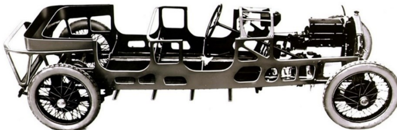
Obr. 4.1: Lancia Lambda jako první automobil se samonosnou kosterou [61]
