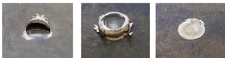
Obr. 11.30: Možné varianty porušení svarů po zkoušce stříhem ukázané na svaru T5113 – částečné vytržení svaru (vlevo), T5117 – symetrické vytržení svaru (uprostřed) a T5114 – porušení v dělicí rovině (vpravo)
