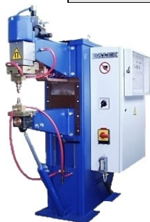
Obr. 11.22: Odporový svařovací lis DALEX PMS 11-4 (vlevo), elektrodové čepičky Typ 39 D 1978-2 (uprostřed) a jejich geometrie (vpravo)
