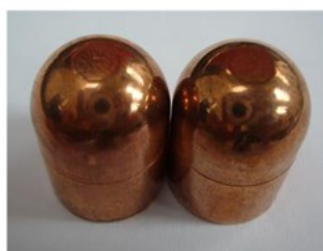
Obr. 11.22: Odporový svařovací lis DALEX PMS 11-4 (vlevo), elektrodové čepičky Typ 39 D 1978-2 (uprostřed) a jejich geometrie (vpravo)
