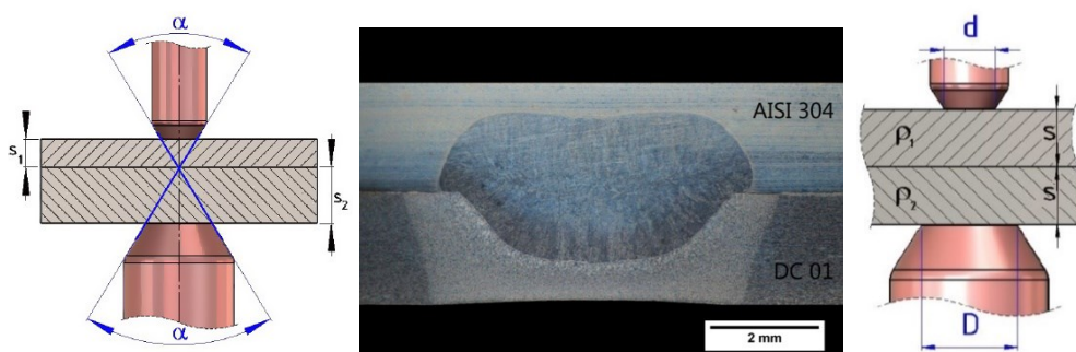
Obr. 3.11: Řešení tepelné rovnováhy. Rozdílné tloušťky svařovaného materiálu (vlevo), heterogenní spoj (uprostřed a vpravo) [35], [36]
