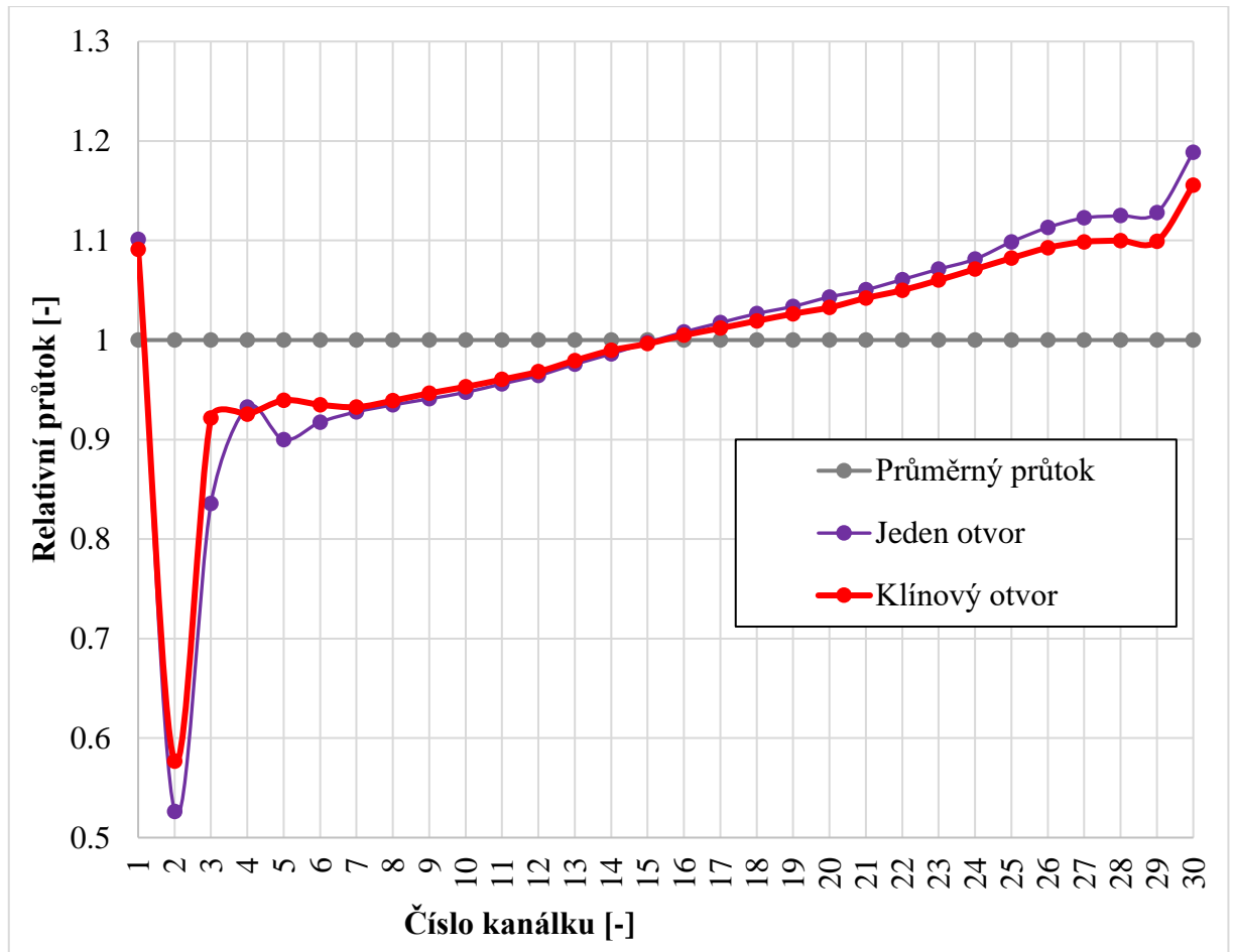
Obr. 6-18 Porovnání průtoků jednotlivými kanálky otopného tělesa pro různé typy distančních kroužků
