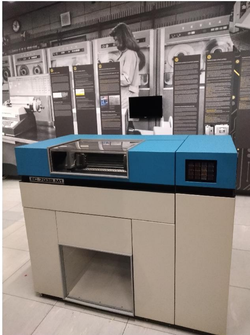
Obrázek D.11: Tiskárna řádková abecedně-číslicová EC 7039 (JSEP – EC 7039) byla řetězová tiskárna s rychlostí 1 200 řádků/min při souboru 84 znaků. Maximální byl soubor 256 znaků při 160 znacích/min. Byla součástí všech československých střediskových počítačů EC 1027 a připojovala se přes multiplexní kanál. Vývoj přístroje realizoval v roce 1979 VÚMS a výrobu ZPA Praha-Jinonice, (fotografie Bc. Petr Neugebauer).
