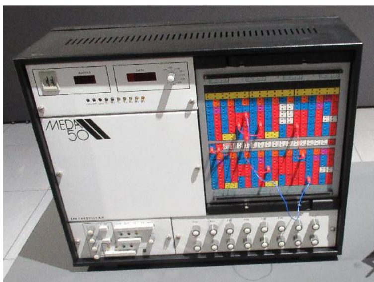
Obrázek D.5: MEDA 50 byl nejmodernější (a poslední) z řady československých analogových počítačů a sloužil k modelování dynamických systémů popsaných soustavami diferenciálních rovnic, k modelování regulovaných soustav a regulačních obvodů, k řešení soustav algebraických rovnic nebo k řešení parciálních diferenciálních rovnic apod. Byl využíván ve školství, (fotografie Bc. Petr Neugebauer).
