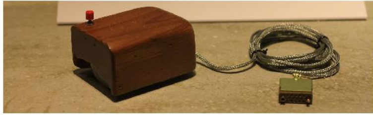
Obrázek 4.19: Prototyp myši Douglase Engelbartse, US Patent 3541541. Převzato z https://commons.wikimedia.org/wiki/File:%EC%A0%9C%EC%A3%BC_Nexon_Computer_Museum_028 (citováno on-line 7. 5. 2021).
