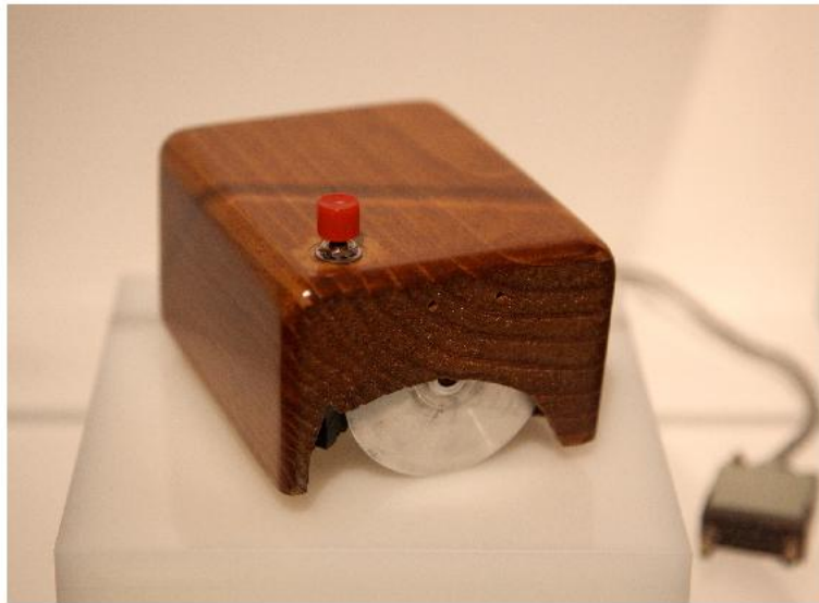
Obrázek 4.20: Detail pohybového mechanismu myši Douglase Engelbartse, US Patent 3541541. Převzato z https://commons.wikimedia.org/wiki/File:%EC%A0%9C%EC%A3%BC_Nexon_Computer_Museum_028 (citováno on-line 7. 5. 2021).
