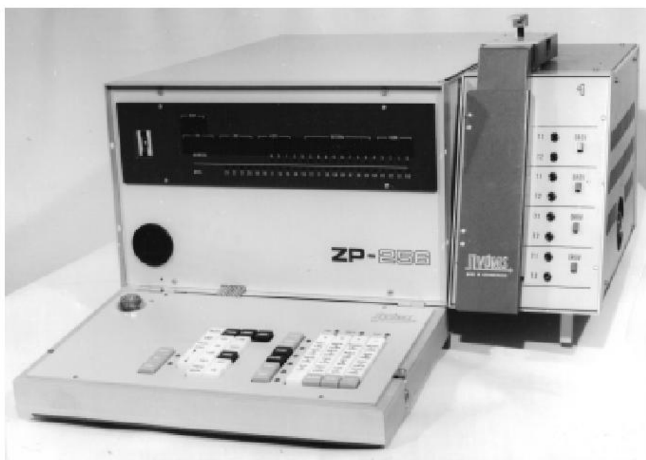
Obrázek 3.68: ZP-256 – systém pro testování pamětí, (fotografie z osobní sbírky Ing. René Kollinera).
