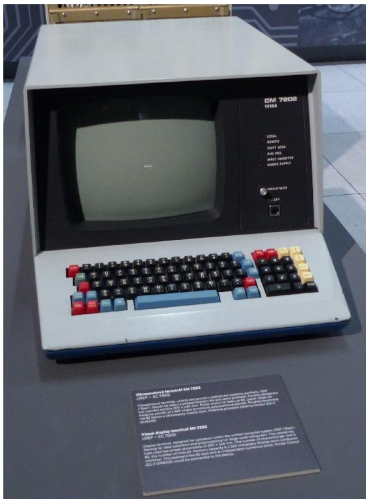
Obrázek D.14: Obrazkový terminál SM 7202 (JSEP – EC 7063) byl určen pro provoz v JSEP i SMEP. Sloužil ke sběru a předzpracování dat pro velké počítače i minipočítače. Použitá obrazovka měla rozměry stínítka 200 \times 140 mm. Počet znaků na řádku byl 80, počet řádků 24. Snímková paměť byla polovodičová a měla kapacitu na zapamatování 1920 znaků. Použitá klávesnice užívala 82 kláves a samostatný číselný blok. Existovala možnost připojení tiskárny Consul 211.3 (SM 6303), (fotografie Bc. Petr Neugebauer).
