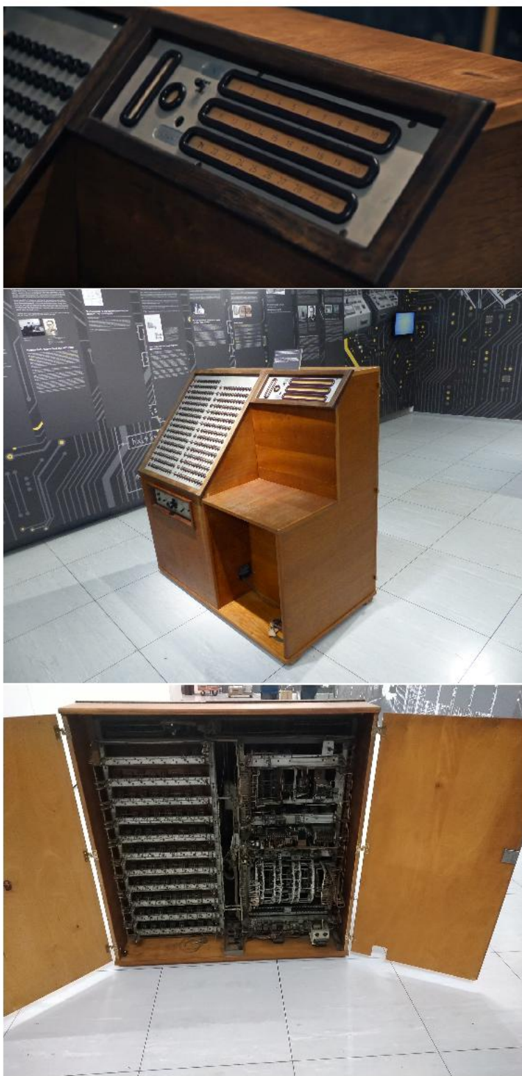
Obrázek D.2: Počítací stroj SuperELIŠKA z roku 1954 navrhl RNDr. Allan Línek a Ing. Ctirad Novák. Počítač byl určen pro výpočet map elektronových hustot a sloužil do roku 1957, (fotografie Bc. Petr Neugebauer).
