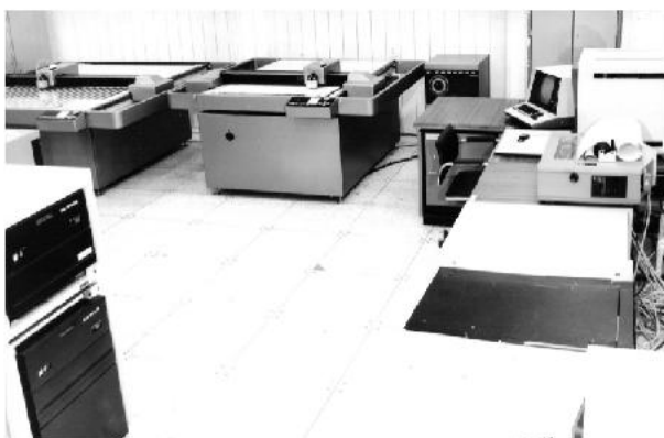
Obrázek 3.60: Zařízení na přípravu dat – kombinací Digigrafu, Digiposu a minipočítače ADT vznikla Interaktivní Grafická Stanice (IGS) , (autorka fotografie Hana Mahlerová, osobní sbírka Ing. P. Golana, CSc.).
