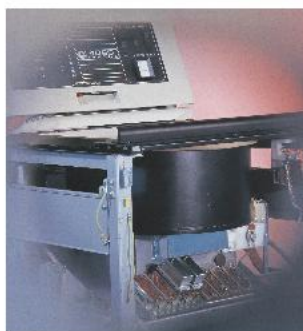
Obrázek 3.63: Disková paměť ARITMA 4080 s kapacitou svazku 100 MB – viz ARITMA 1950–1980 . ARITMA Praha podniková publikace, Praha 1985.
