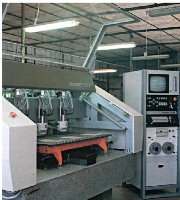
Obrázek 3.73: VPS 1701 – souřadnicová vícevřetenová vrtačka plošných spojů. Foto převzato z publikace 35 let ARITMY , Praha 1985.
