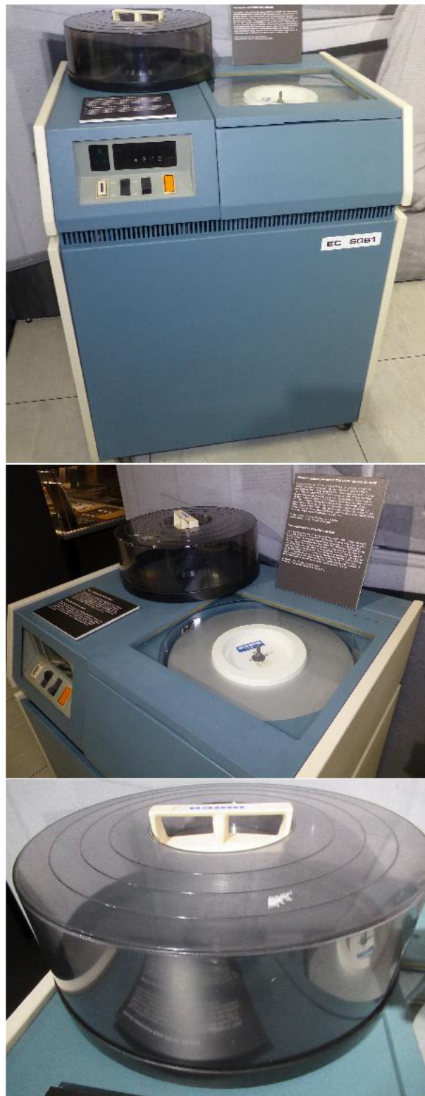
Obrázek D.9: Disková magnetická jednotka EC 5061 (JSEP – EC 5061/EC 1055). Kapacita jednoho disku byla 29 MB s rychlostí 312 KB/s. Diskovou jednotku v rámci RVHP vyráběla Diskovi Zapametyavashti Ustroistva (DZU) ve Staré Zagore a diskové svazky firma IZOT, obě v Bulharsku, (fotografie Bc. Petr Neugebauer).
