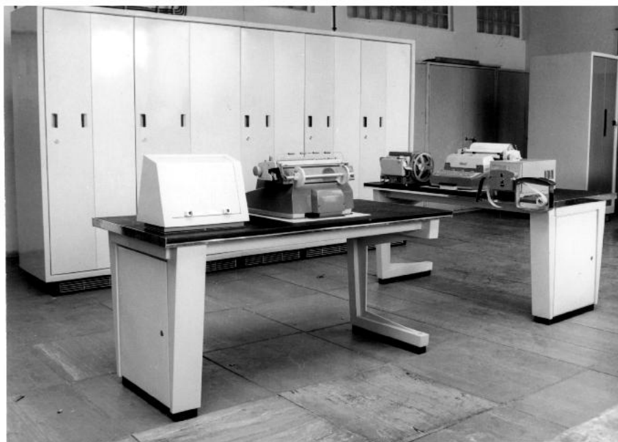
Obrázek 3.37: Řídicí počítač ŘÍP 1000, (autorka fotografie Hana Mahlerová, osobní sbírka Ing. P. Golana, CSc.).
