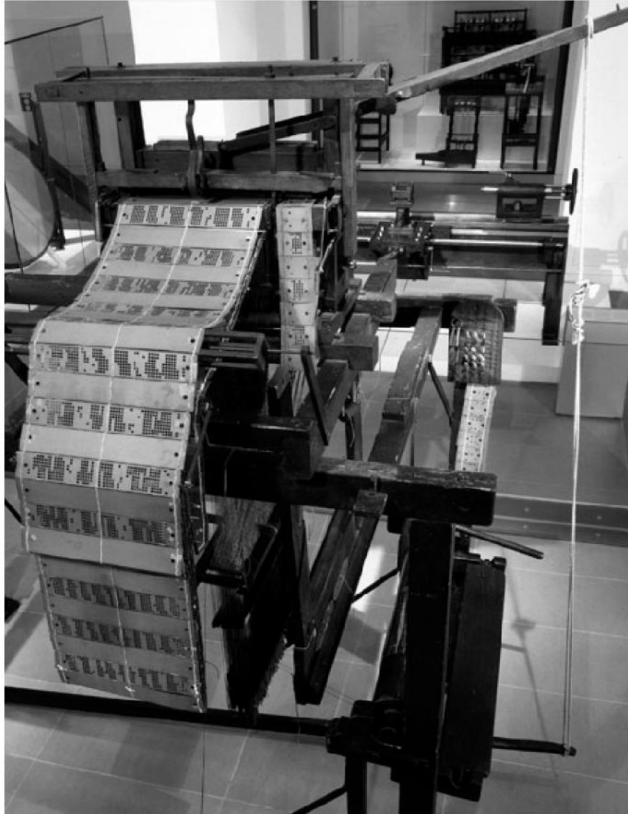
Obrázek 1.2: Jacquardův textilní stroj řízený děrnými šítky. Převzato z ES-SINGER, James. Jacquard's Web: How a Hand-loom Led to the Birth of the Information Age . OUP Oxford 2007, p. 281.
