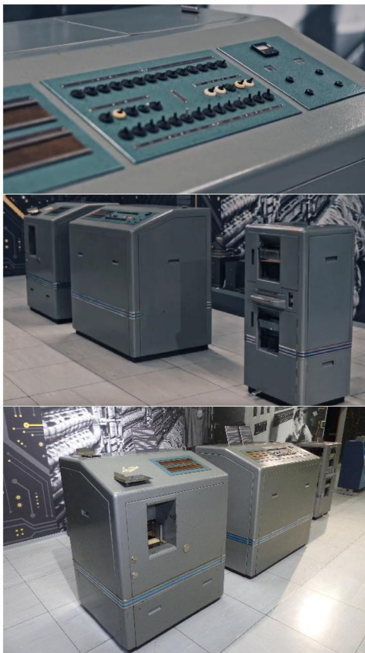
Obrázek D.3: Děroštitkový počítač Aritma 521 byl tvořen dvěma samostatnými jednotkami propojenými kabeláží. Jedna skříň obsahovala snímací a děrovací zařízení pro děrné štítky, ve druhé byla umístěna aritmetická jednotka s reléovou logikou. Počítač pracoval s 90sloupcovými děrnými štítky, rychlost zpracování byla 6000, popř. 3000 štítků, za hodinu a umožňoval provádět základní početní úkony a jejich kombinace. Vznikl v letech 1957 až 1958 ve spolupráci n. p. ARITMA a kolektivu pracovníků Ústavu matematických strojů ČSAV pod vedením Antonína Svobody, (fotografie Bc. Petr Neugebauer).
