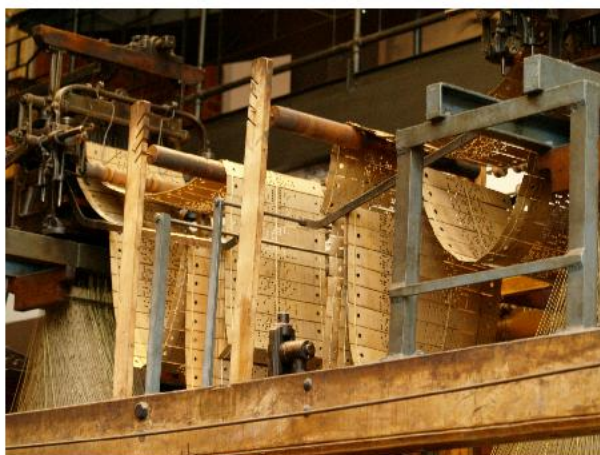
Obrázek 2.15: Detailní pohled na dřevěné štítky v žakárovém stavu. Vystaveno v Deutsches Technikmuseum Berlin , foto muzea z února 2008. Převzato z https://technikmuseum.berlin (citováno on-line 30. 2. 2021).
