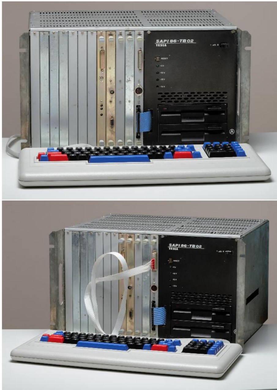
Obrázek D.15: SAPI86-TB02 – Klon IBM PC XT využíval mikroprocesor KM 1810 VM 86 (ekvivalent INTEL 8086), dynamickou paměť 512 KB RAM, 5,25" disketové mechaniky. Bylo možné k němu připojit barevný monitor CGA nebo černobílý HERCULES. Modulární systém byl identický jako u SAPI-1, (fotografie Bc. Petr Neugebauer).
