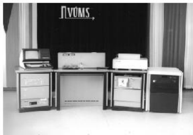
Obrázek 3.71: ZKD 500 – systém pro testování desek osazených logickými IO, (fotografie z osobní sbírky Ing. René Kollinera).
