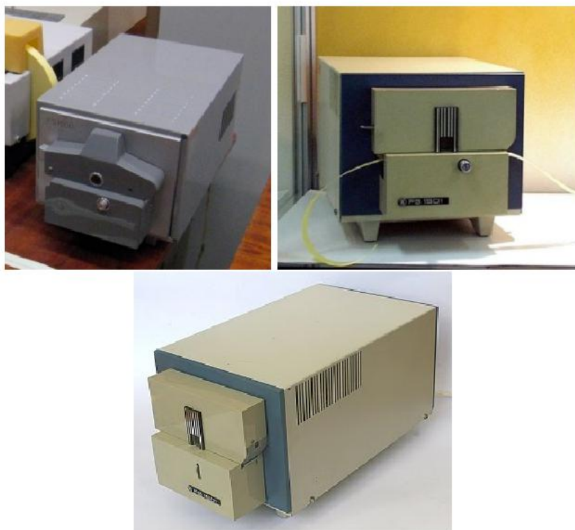
Obrázek 3.55: Snímače děrné pásky FS 1500, FS 1501, FS 1503, (fotografie z osobní sbírky Ing. René Kollinera).
