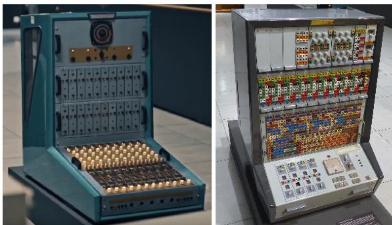
Obrázek D.4: Diferenciální analyzátoři MEDA. Ve spolupráci VÚMS a n. p. ARITMA Praha vznikly malé elektronkové analogové počítače MEDA 1 a MEDA 2 i tranzistorový počítač MEDA 41TC, používaných např. k řešení soustav diferenciálních rovnic. Sériově se vyráběly od roku 1964, (fotografie Bc. Petr Neugebauer).
