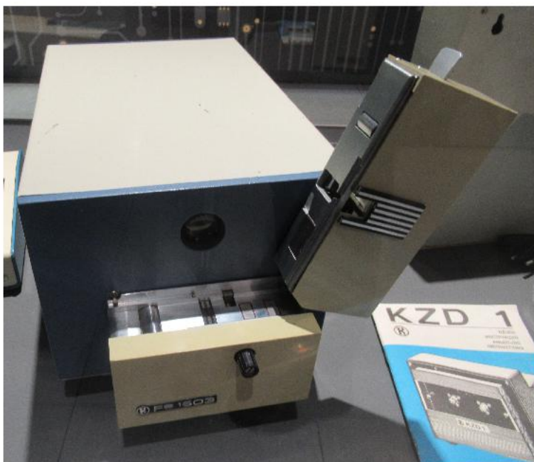
Obrázek D.10: Fotoelektrický snímač děrné pásky FS 1503 (JSEP – EC 6122). Fotoelektrický snímač děrné pásky byl určen k zavádění informací vyznačených otvory v děrné pásce do zařízení na zpracování informací, samostatných a speciálních počítačů a k programovému řízení obráběcích a textilních strojů. Umožňoval použít děrnou pásku o šířce 5, 6, 7 a 8 stop. Byl řešen jako samostatný stolní přístroj. Typ FS 1503 bylo zařízení postavené na integrovaných obvodech a bylo inovací předchozího typu FS 1501, osazeného křemíkovými tranzistory. Tyto dva typy vycházely z původní koncepce foto-snímače FS 1500, vyvinutého v Závodech Jana Švermy (ZJŠ) Brno/VÚMS. FS 1503 vyvinuly a vyráběly ZPA Praha-Košíře v letech (1971–1989), (fotografie Bc. Petr Neugebauer).
