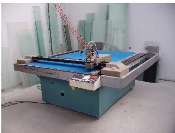
Obrázek 3.59: Úprava Digigrafu pro řezání skla. Foto převzato z https://www.ecsnb.cz/aplikace-dgf4g.html (citováno on-line 1. 2. 2021).
