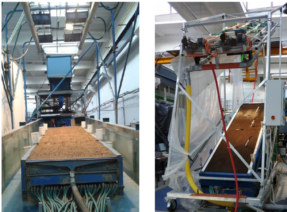
Obrázek 2: Laboratorní simulátor Fsv ČVUT připraven k experimentu. Vlevo experiment před přestavbou, vpravo simulátor po přestavbě ve sklonu 30^\circ . (foto T. Laburda a M. Neumann)
