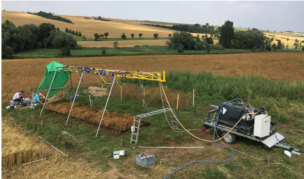
Obrázek 1: Polní dešťový simulátor Fsv ČVUT během měřicí kampaně. Vpravo je přívěs s elektronikou, zásobníkem na vodu a čerpadlem vody. Rameno simulátoru je nad experimentální plochou a v levé části je vidět pracovníky odebírající povrchový odtok z plochy. (foto T. Laburda)
