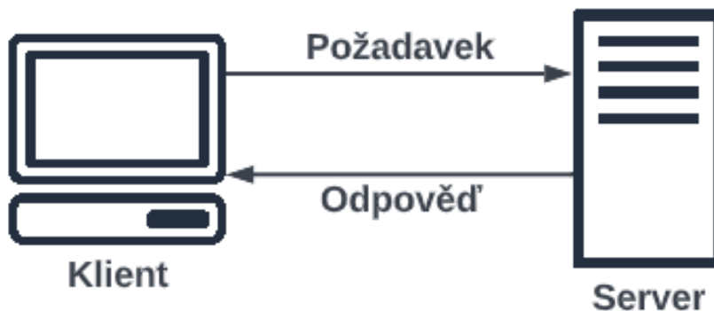
Obrázek 2.3: Klient-server architektura. Převzato a upraveno podle zdroje: [4]
