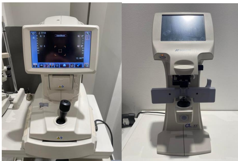
Obrázek 21: Auto refraktometr TOPCON KR-800 (vlevo), Automatický fokometr TOPCON LC-300 (vpravo) [zdroj: vlastní]
