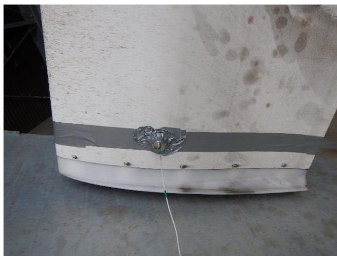
Obr. 36: Umístění snímače vibrací na lopatce
