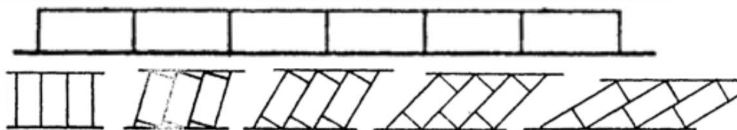
Obrázek 7: Schématické znázornění podélných, kolmých a šikmých stání
