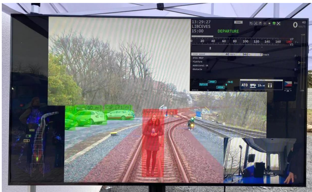
Obrázek 2 - Sledování prostoru před vlakem pomocí senzorů (zdroj: https://zdopravy.cz/wp-content/uploads/2021/12/azdvlak2.jpg )
