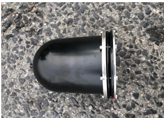
Obrázek 17 – Dopravní klasifikátor před instalací (Beneš, 2020)
