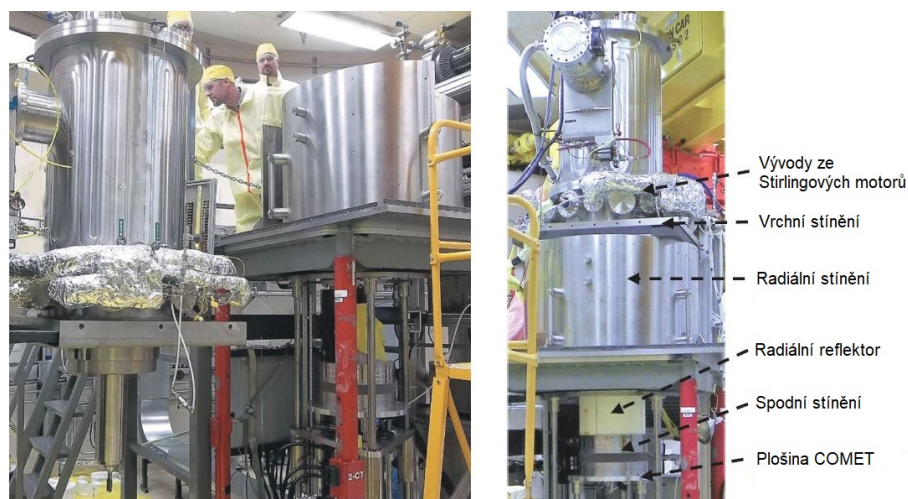
Obrázek 40: Fotografie systému KRUSTY s plošinou COMET, přeloženo z angličtiny. Převzato z [60].
