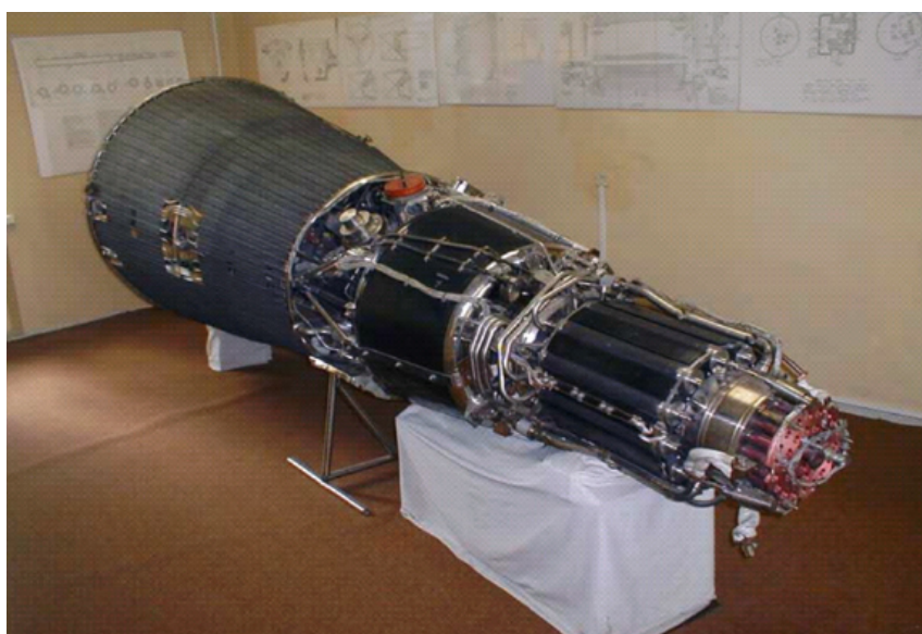
Obrázek 34: Model systému TOPAZ-I, převzato z [57].
