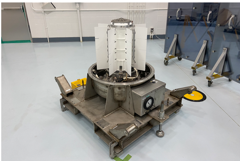
Obrázek 48: Fotografie radioizotopového zdroje MMRTG. Převzato z [63].
