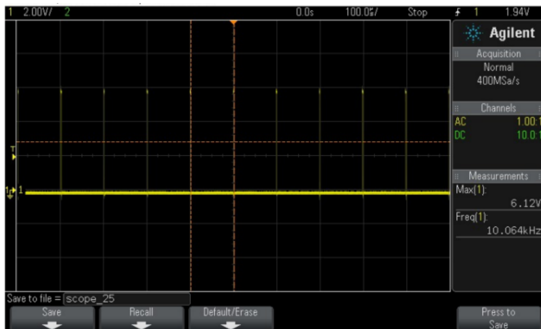
Obrázek 1.9: Vliv kondenzátoru na amplitudu impulzů - úzké impulzy [2]
