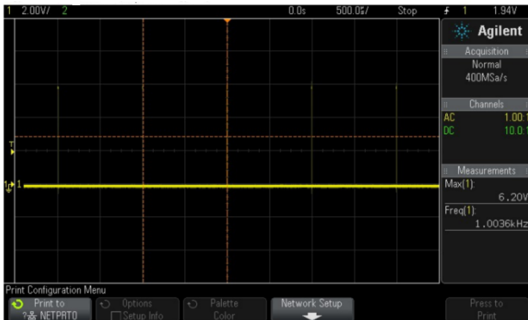
Obrázek 1.8: Vliv kondenzátoru na amplitudu impulzů - žádná četnost [2]
