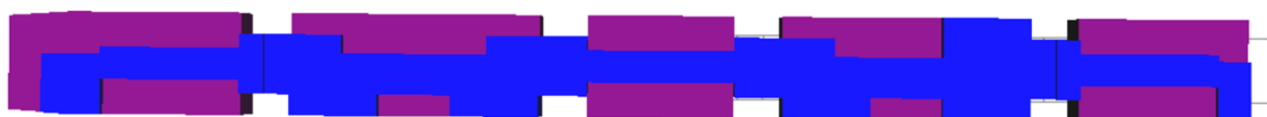
Obr. 67 – Tělesa užitečných zatížení v modelu tramvajové jednotky. Modrá – stojící cestující, fialová – sedící cestující. Modely skříně jsou skryty.
