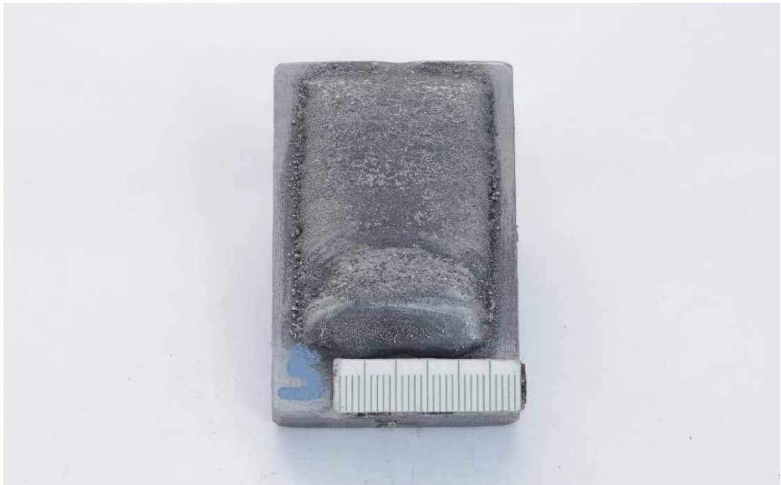
Obrázek 36: Vzorek číslo 5, 85 % Nibasit 625 – P/LFe ® , 15 % B 4 C.
