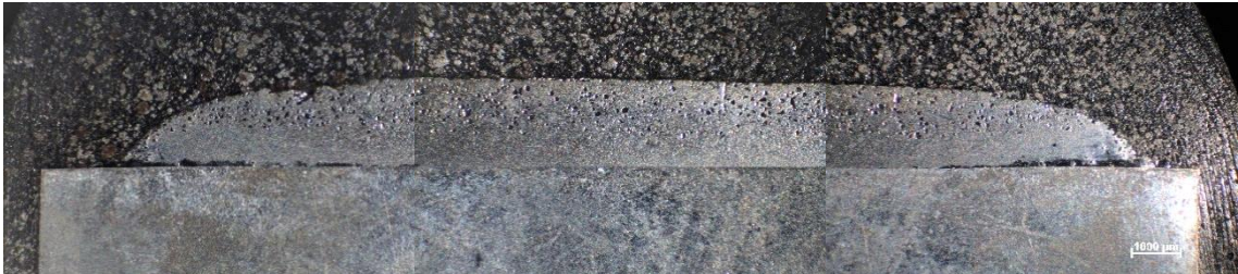
Obrázek 44: Makrostruktura návaru s 15 % B 4 C (vzorek 5).
