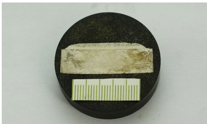
Obrázek 26: Metalografický výbrus návaru (vzorek 5).
