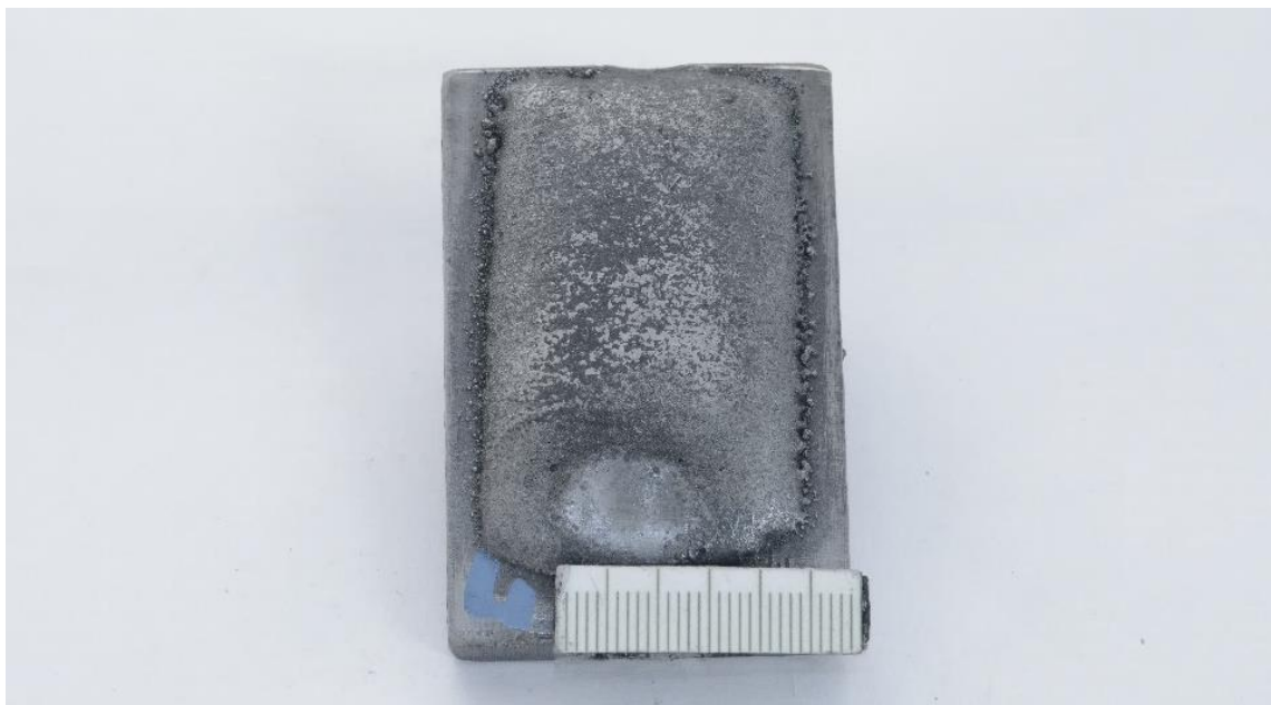
Obrázek 34: Vzorek číslo 4, 85 % Nibasit 625 – P/LFe®, 15 % B 4 C.
