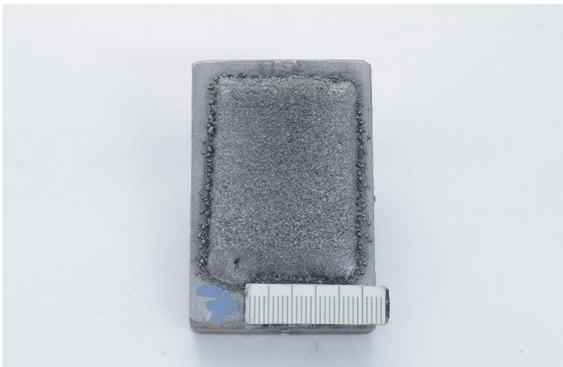
Obrázek 39: Vzorek číslo 7, 70 % Nibasit 625 – P/LFe ® , 30 % B 4 C.
