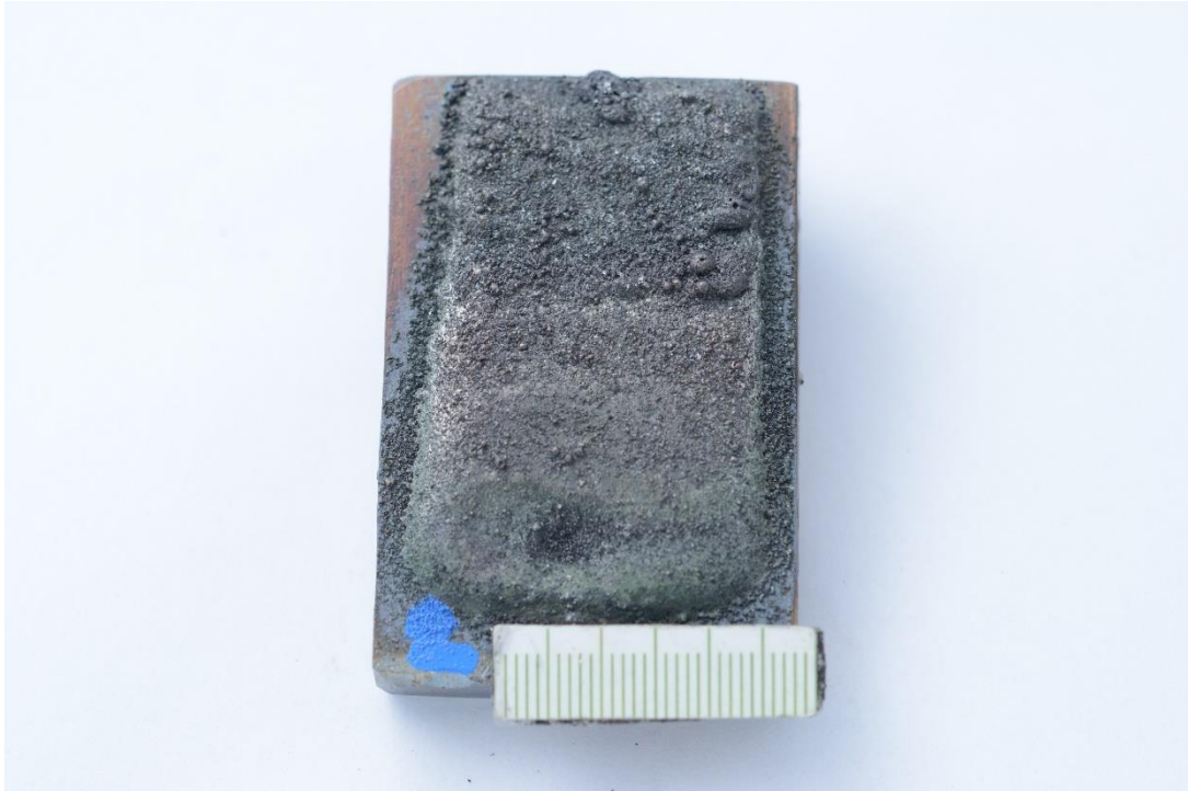
Obrázek 38: Vzorek v 30 % B 4 C před úpravou parametrů navařování.
