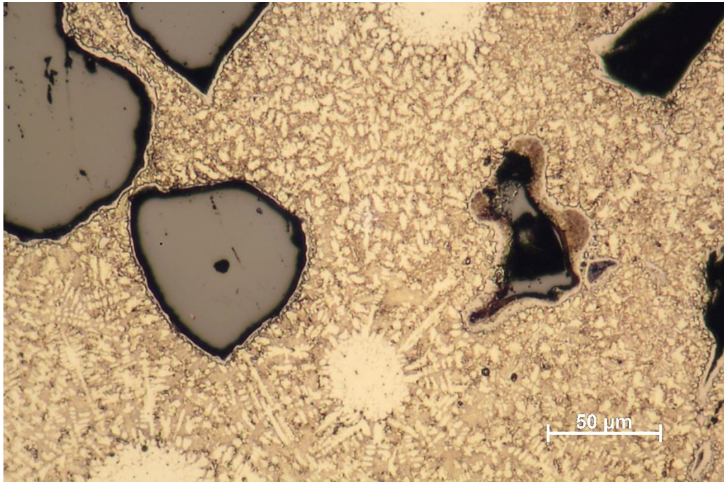
Obrázek 51: Mikrostruktura návaru pod povrchem (vzorek 7) – OM, 240x.
