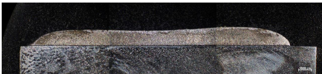
Obrázek 43: Makrostruktura návaru se 100 % Nibasitu 625 – P/LFe ® (vzorek 1).
