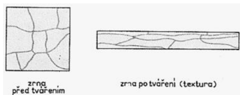
Obrázek 4: Zrna před tvářením a zrna po tvářením [7]
