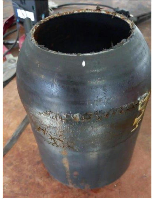
Obrázek 30: Neplatná zkouška - použití tuhého maziva
