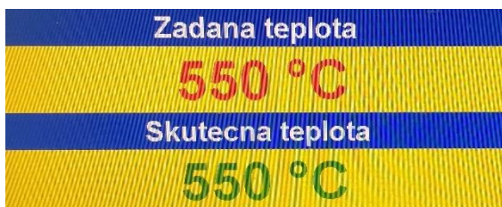
Obrázek 37. Teplota z ovládacího panelu žíhací pece (550 °C)
