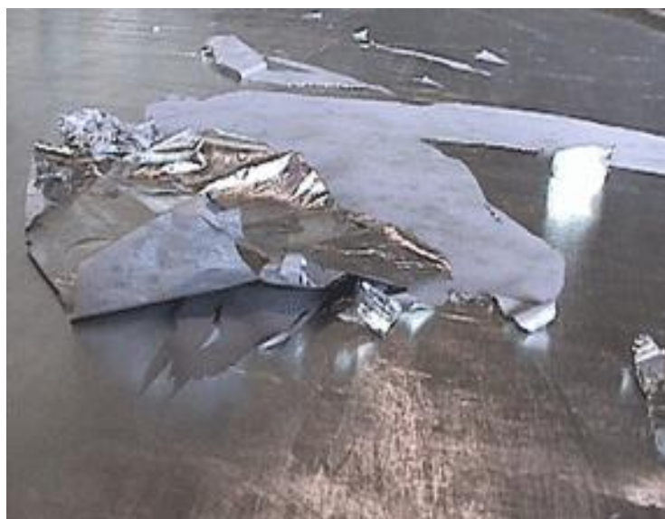
Obrázek 23. Delaminace povlaku tvořeného čistým zinkem [43]
