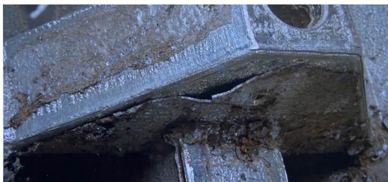
Obrázek 21. Fe-Zn krusta na tlustostěnných konstrukcích s vysokým obsahem křemíku [4]
