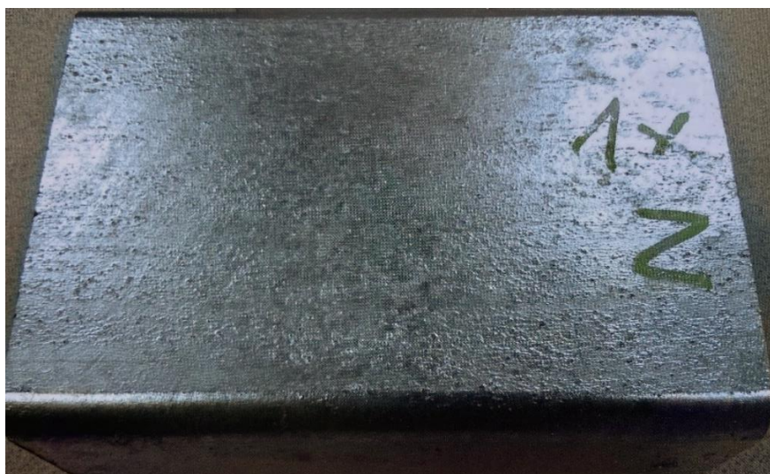
Obrázek 24. Drsný povrch zinkového povlaku vlivem primární delaminace [4]
