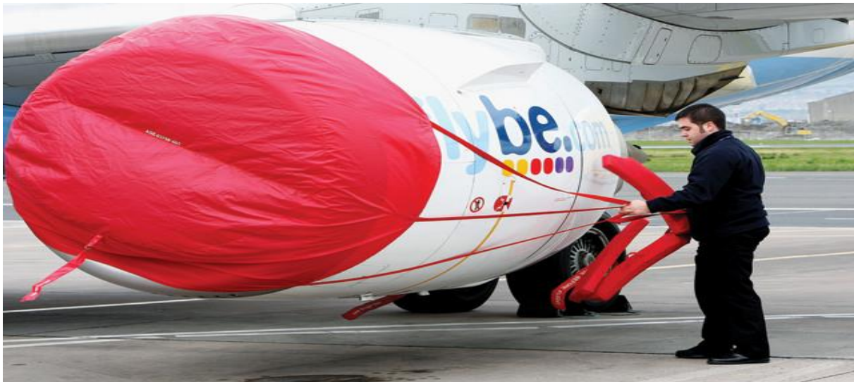
Obrázek 1: Příklad zachování motoru proti sopečnému popelu anglické letecké společnosti Flybe [93]
