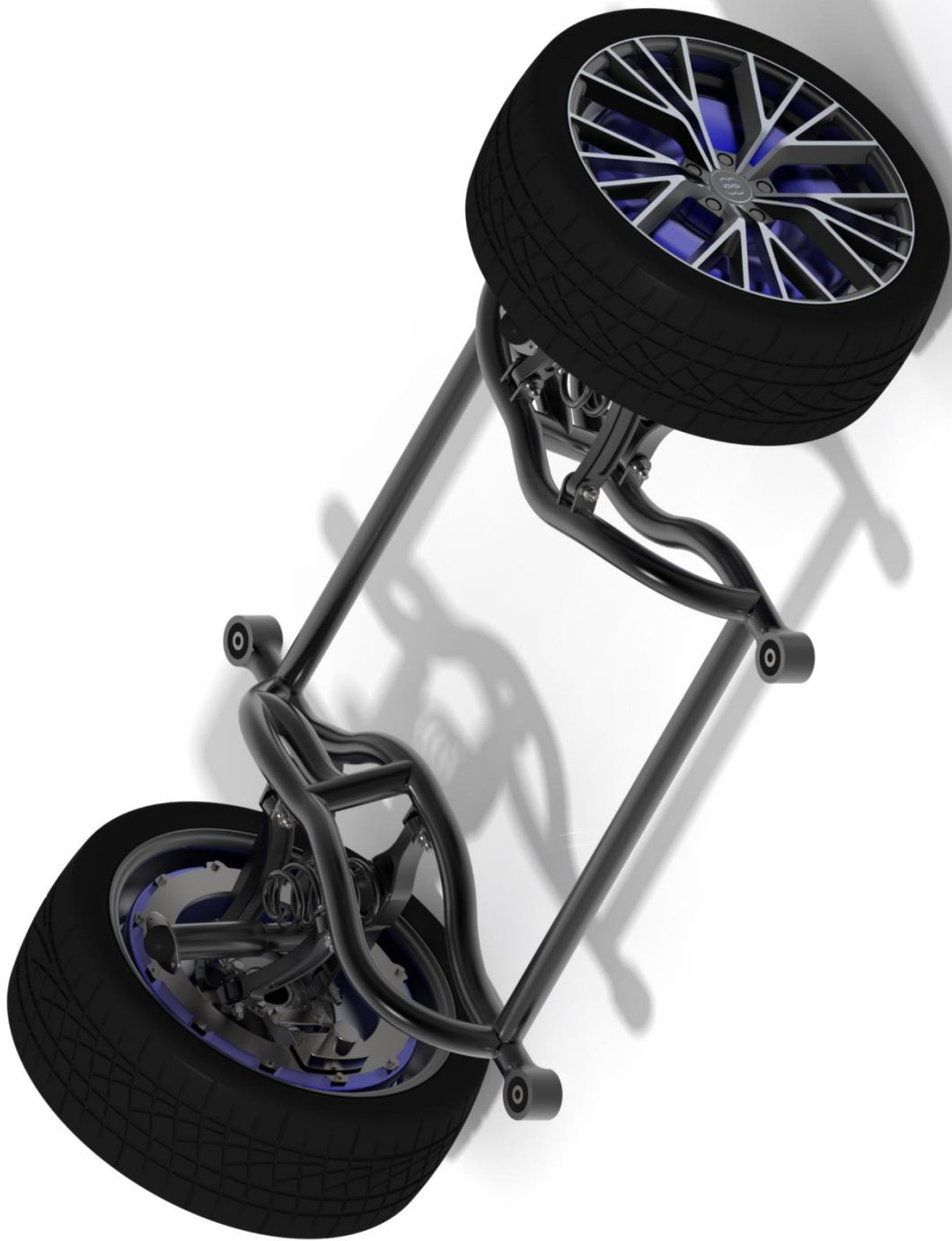
Obrázek 44: Izometrický zadní pohled na CAD model nápravy
