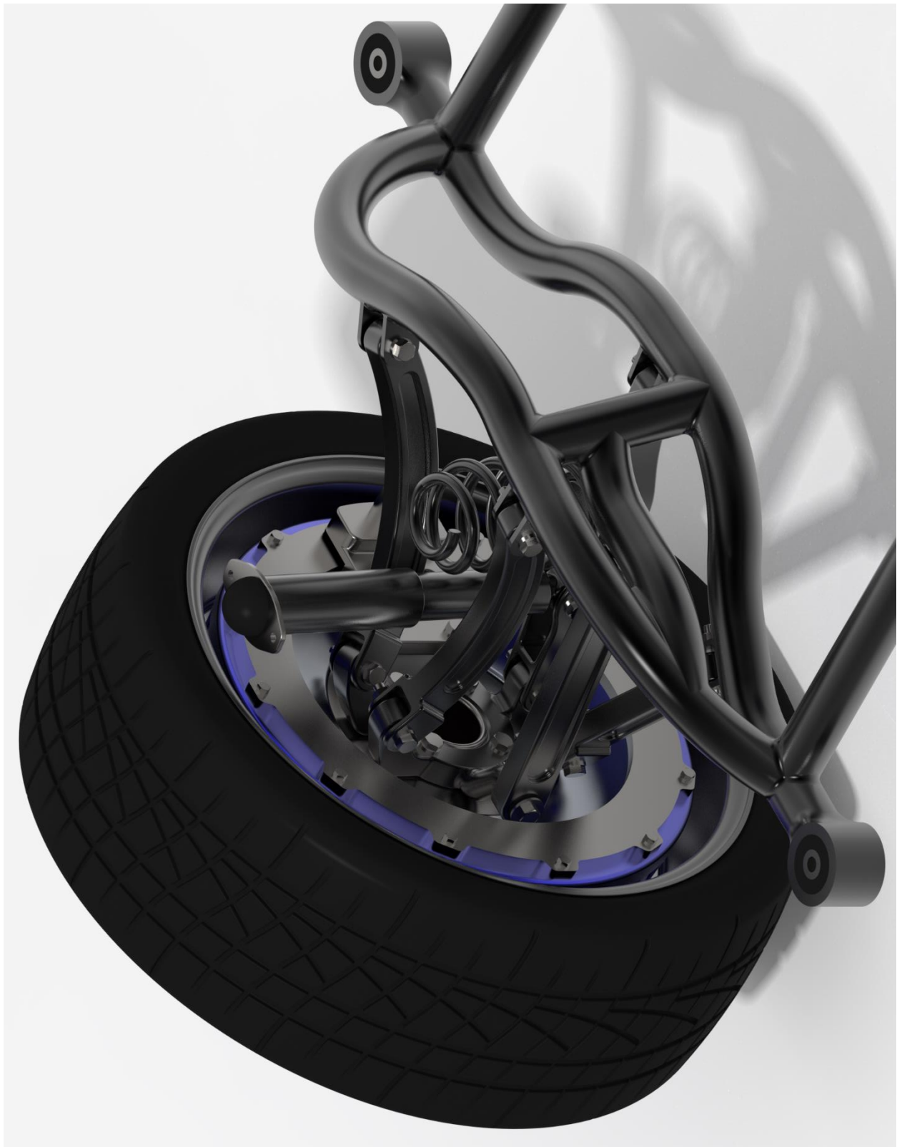
Obrázek 46: Detailní přední pohled na CAD model zavěšení kola
