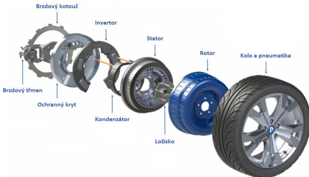
Obrázek 12: Elektromotor v náboji kola [16]
