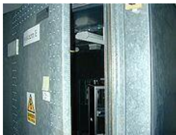
Obr. č. 1 – Faradayova klec v laboratorních podmínkách
