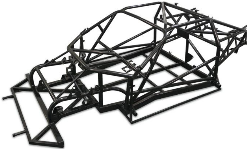
Obrázek 5 - Trubkový rám sportovního vozu K-1 Attack [23]
