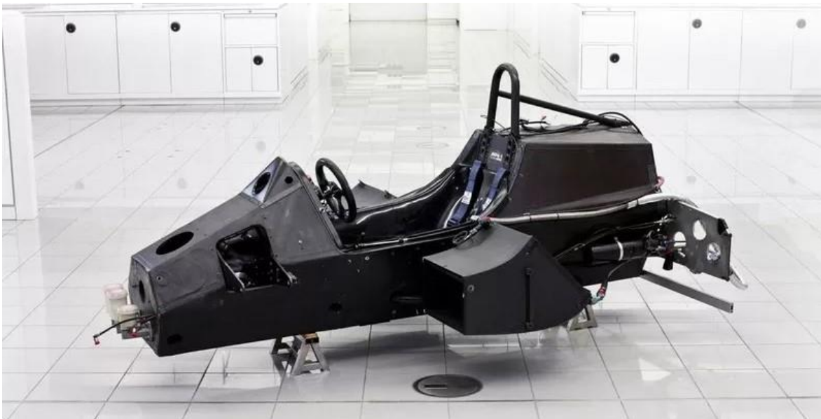
Obrázek 9 – Monokok z uhlíkových vláken vozu F1 McLaren MP4/1 [33]
