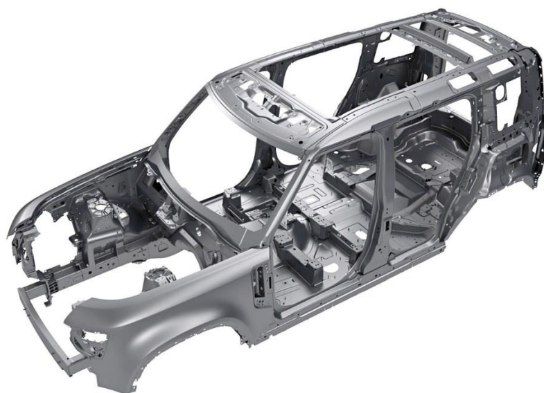
Obrázek 6 - Samonosná karoserie z lisovaných plechů vozu Land Rover Defender [26]
