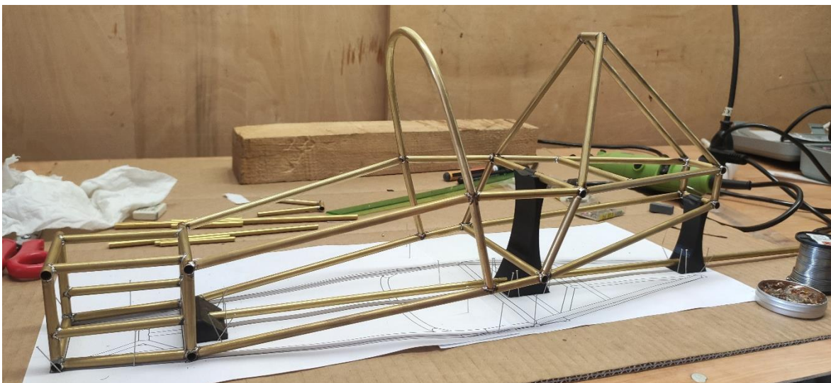
Obrázek 84 - Propojení všech hlavních částí rámu propojujícími trubkami
