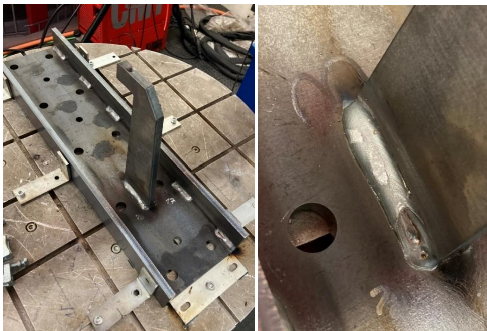
Obrázek 46: Vzorek č. 3 – přivaření háku (vlevo) s detailem svaru (vpravo)
