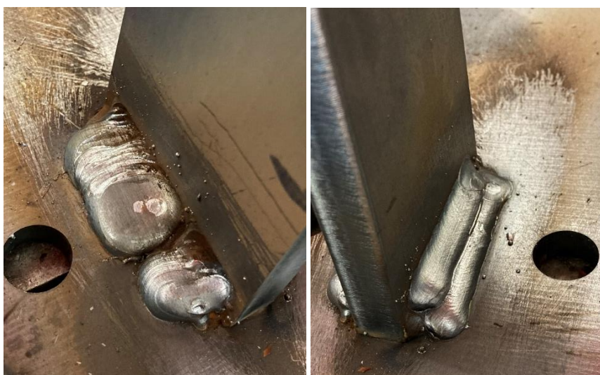
Obrázek 54: Vzorek č. 5 - přivaření háku s použitým rozkyvem (vlevo) přivaření háku 3 – vrstvým svarem (vpravo)
