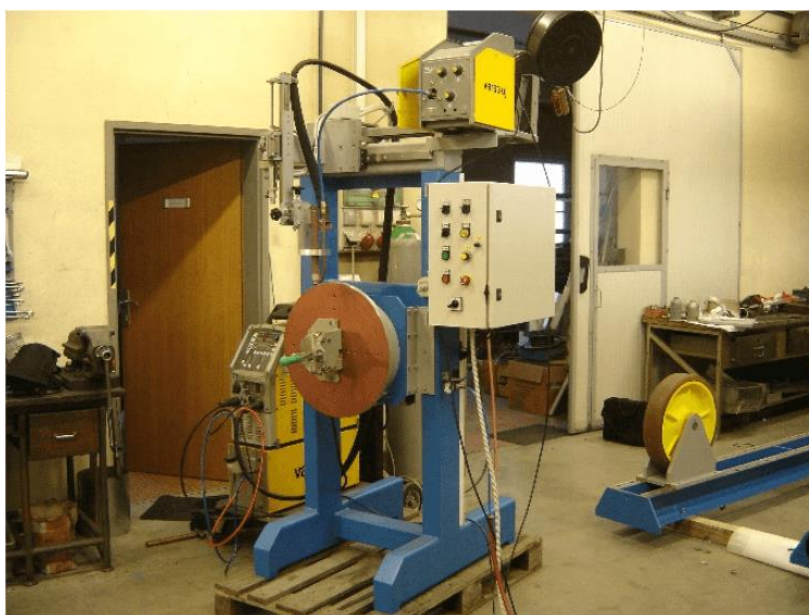
Obrázek 33: Svařovací automat KMO 111 pro svařování přírub, komínových kolen a dalších kruhových součástí [33]
