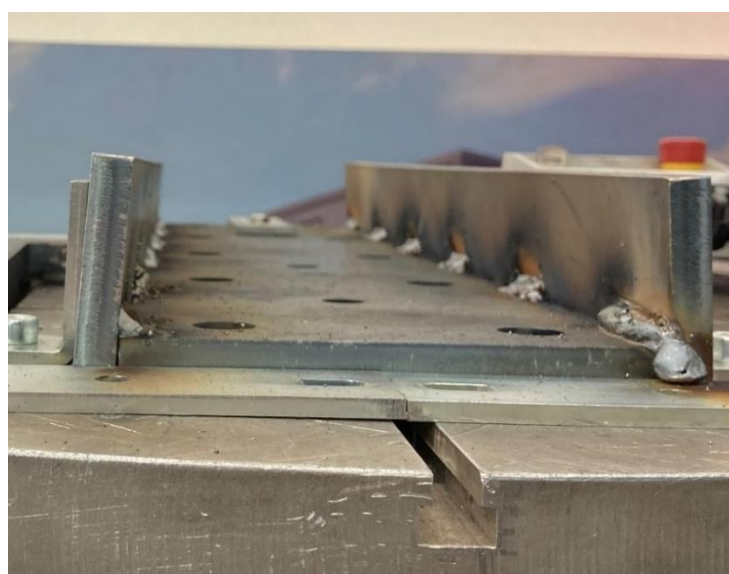
Obrázek 43: Vzorek č. 1 - deformace pásnic vlivem chladnutí
