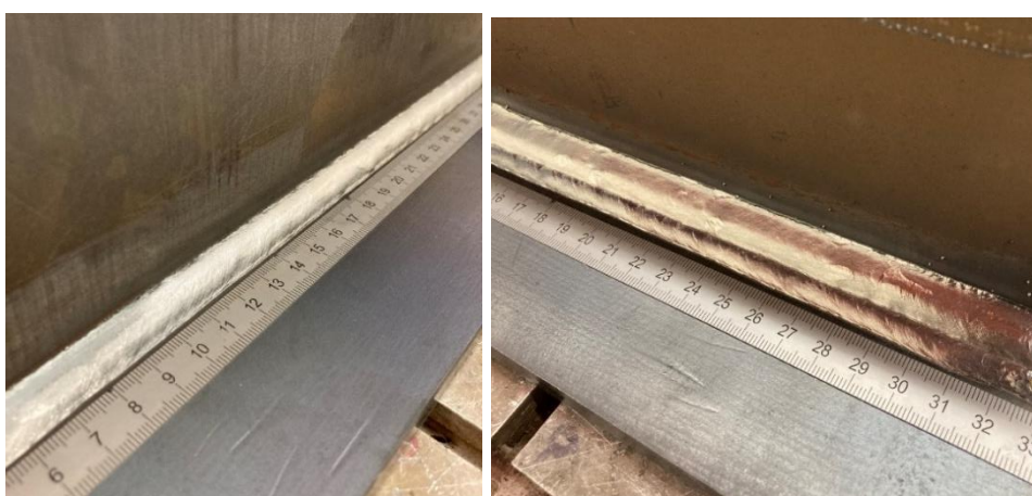
Obrázek 64: Detail 1 – vrstvého svaru a7 (vlevo), detail 3 - vrstvého svaru a8 (vpravo)
