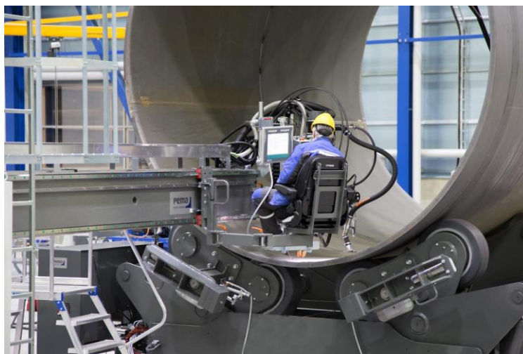
Obrázek 21: Svařování automatizovanou metodou SAW s využitím kladkového polohovadla [21]
