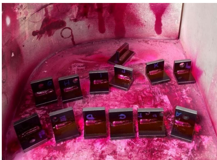
Obrázek 48: Nanášení indikátoru na vzorky
