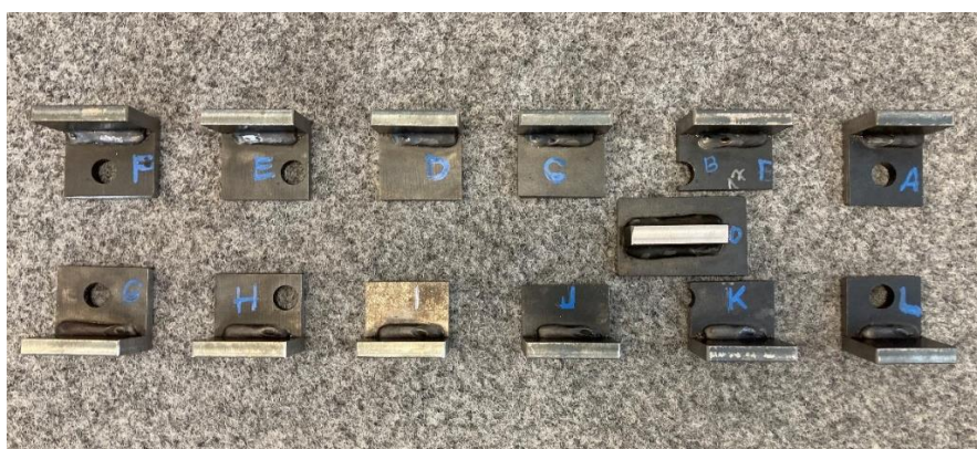
Obrázek 47: Rozdělení vzorku č.3. na vzorky svarů A až O
