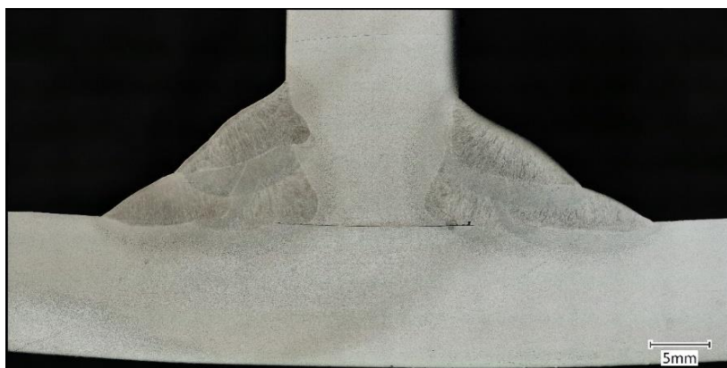
Obrázek 75: Makroskopický snímek 3vrstvého svaru a8
