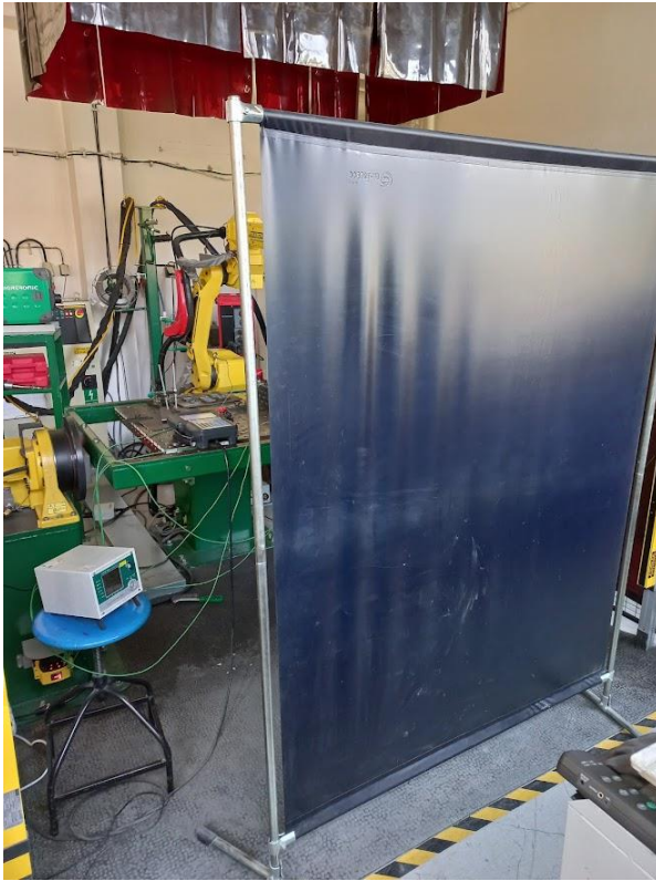
Obr. 43 Umístění zástěny do pracovního prostoru robota
