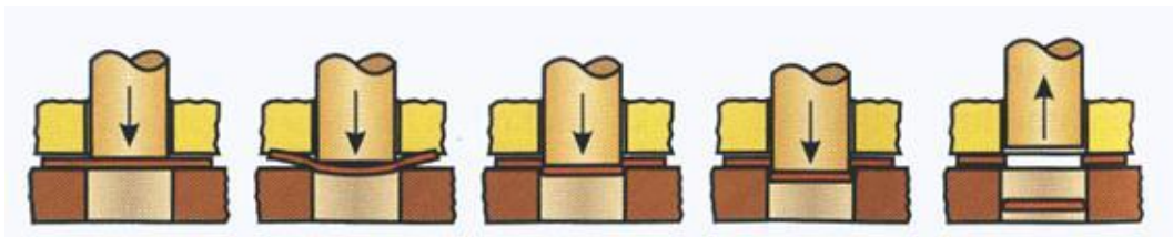
Obrázek 3 - Princip stříhání otvoru [1]
