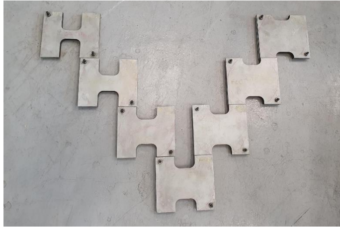
Obrázek 30 - Vyříznuté vzorky vyskládané do tvaru FLC
