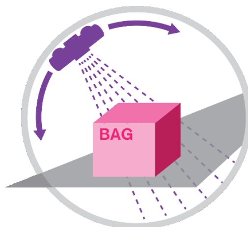
Obrázek 8: princip snímání zavazadla CT RTG [33], upraveno autorem
