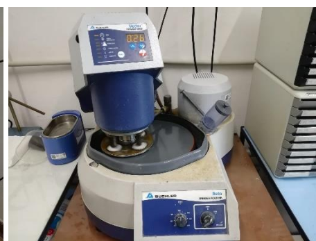
Obrázek 38: Metalografická bruska Beuhler Beta
